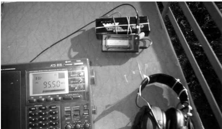
Decoder per RDS della Micromed; alimentazione con batteria pb a 12 volt
