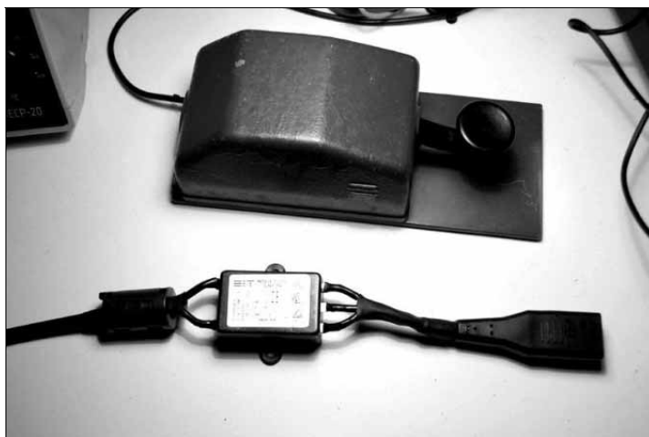
Il nuovo cavo d'alimentazione del PC con il filtro di rete installato.
