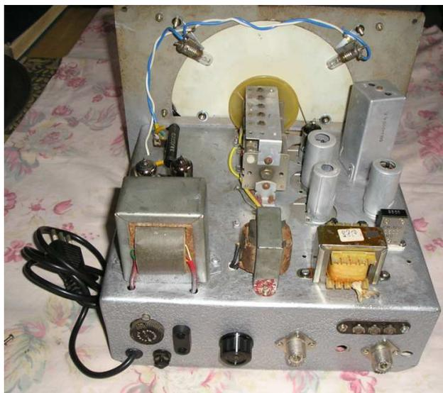
A sua volta collegato ad un qualsiasi radio casalinga che fosse sintonizzabile sulla frequenza di 4,6 MHz ottenendo un ricevitore a doppia conversione abbastanza affidabile, naturalmente i massimi risultati si ottenevano dalla qualità del ricevitore adottato spesso si utilizzavano vecchi ricevitori militari che comprendevano la gamma dei 4,6 MHz tipo BC 454 o BC 453 se non ricordo male.
