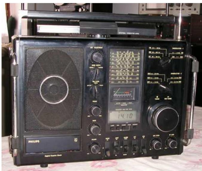
Mentre il modello **AL 990** degli anni ottanta molto piú raro ed evoluto è dotato di lettura digitale della frequenza , di numerosi controlli indispensabili per l'ascolto di segnali in SSB CW AM (OL-OM-OC 1,6-26,2MHz) e per l'ascolto della gamma FM , anche questo acquistato in un mercatino
