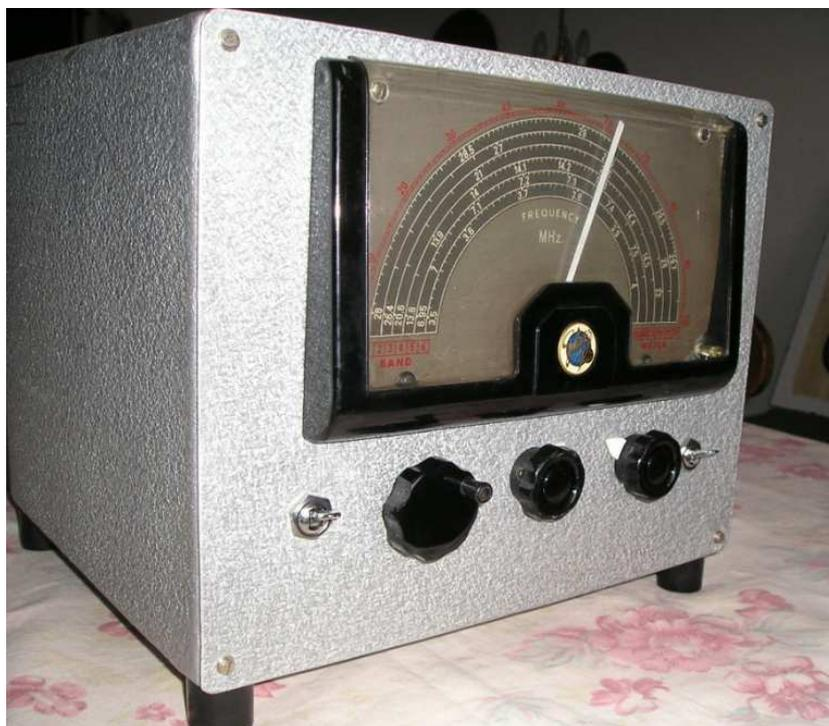
**Convertitore Geloso per bande HF, realizzato con un gruppo RF Geloso N.2017 per le bande dei 10-11-15-20-40-80 metri**
