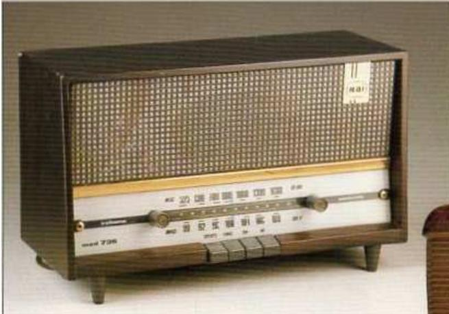
⊗ Radioricevitore IMCA mod. "Pangamma", OCC - OC - OM - MF, supereterodina, 7 valvole, alimentazione a rete universale (1951). A destra: dettaglio della scala parlante a specchio. Il più prestigioso ricevitore costruito dall'industria italiana nel dopoguerra.
