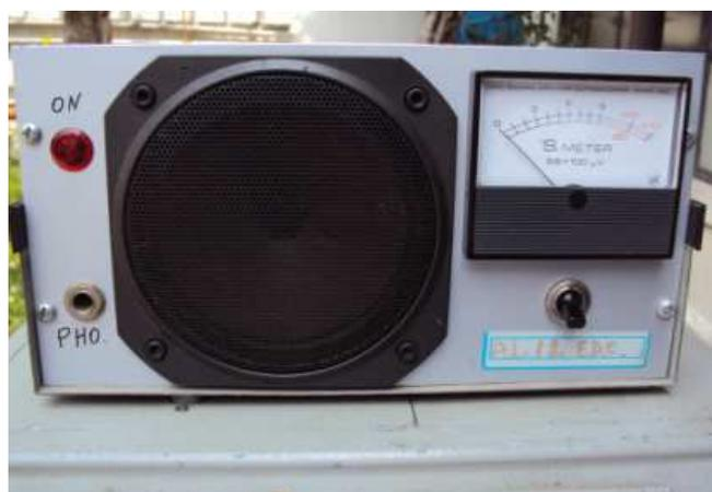
**Alimentatore con altoparlante auto costruito per il ricevitore AR18**
