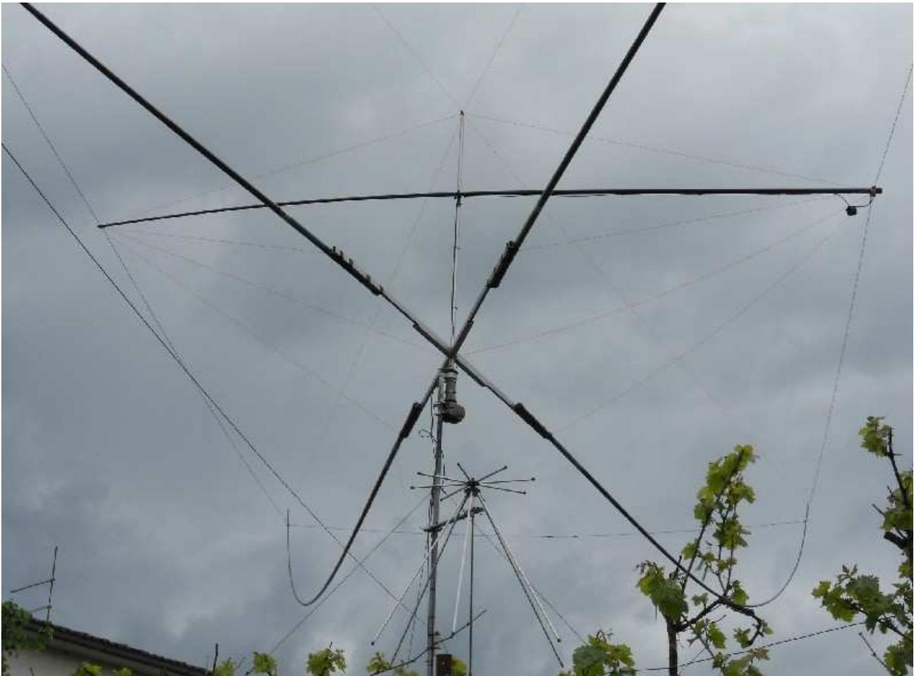
Nell'immagine soprastante vediamo la struttura della MOXON, con il piccolo rotore d'antenna ad uso TV, questo è stato convenientemente rinforzato con due cuscinetti a doppia corona per supplire ai momenti tangenziali e verticali.
