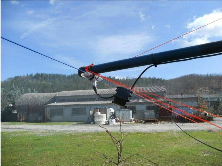
Il punto di alimentazione è ricavato da una base in policarbonato su cui è fissato un PL femmina da pannello, è possibile anche collegare direttamente il coassiale.
