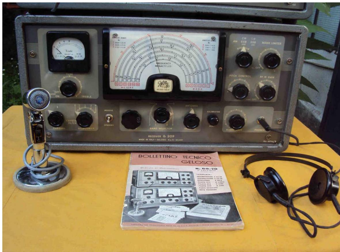
**G209-R** ricevitore Geloso a 6 gamme radiometriche 10-11-15-20-40-80 metri AM-SSB-CW
