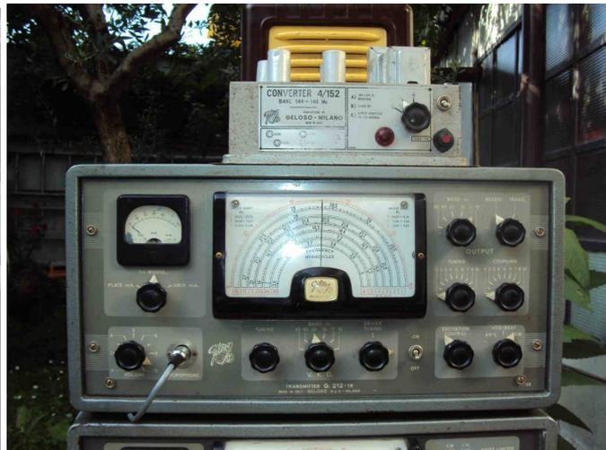
Trasmittitore Geloso G212 TR (60W)
