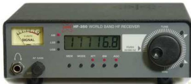
**Lowe HF-350** è essenzialmente è un Palstar R30 configurato per la distribuzione in Europa. La copertura è da 100 kHz a 30 MHz in modalità CW AM, LSB, USB, **fuori produzione** si trova usato.
