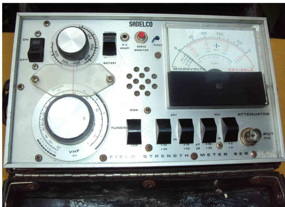
Strumento della **Sadelco** anni sessanta transistorizzato dotato di amplificatore interno di BF per il monitoraggio audio ,dotato di vari comandi ausiliari per gamme VHF FM e UHF.
