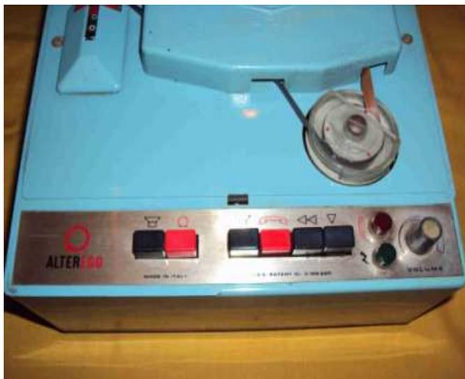
Segreteria Alterego con nastro loop con ritorno automatico, particolare del nastro circolare ad anello chiuso
