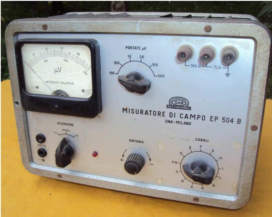
Strumento **Unaohm** mod. EP504B, uno dei primissimi modelli valvolare per gamma tv VHF e radio FM di notevoli dimensioni ed abbastanza pesante che ne limitava l'utilizzo sui tetti .
