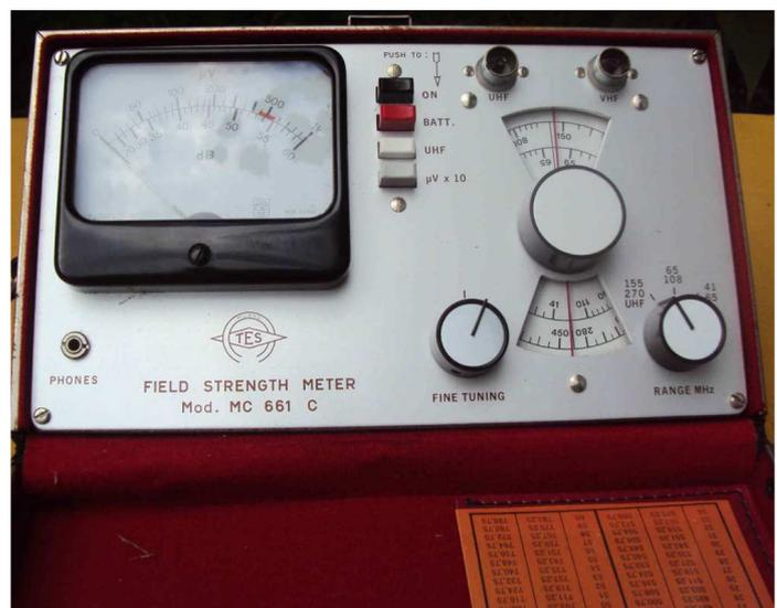
Strumento a transistor degli anni sessanta della **TES** di Milano modello MC 661 C per VHF e UHF molto diffuso tra gli installatori di antenne
