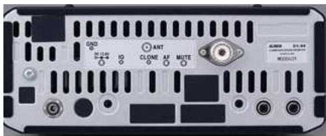
Ricevitore **DX-R8T/E**, funziona da 150 kHz 35MHz in AM/USB/LSB/CW/FM
