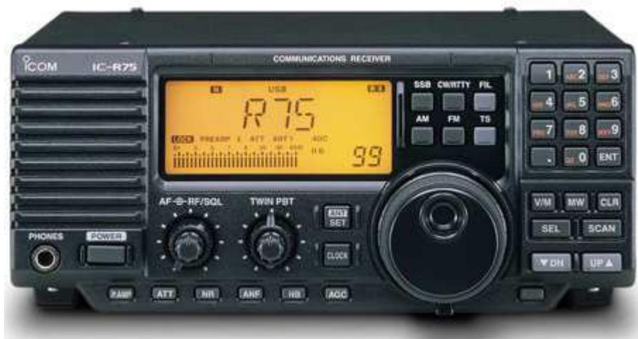
**Ricevitore banda** continua da 30 kHz a 60 MHz USB, LSB, CW, RTTY, AM, FM. Tripla conversione supereterodina. DSP. Il ricevitore non si trova in vendita in Italia ma solo in USA
