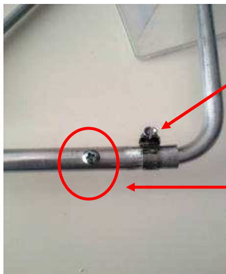
Foto 3: il particolare di "sintonia fine" del dipolo.
