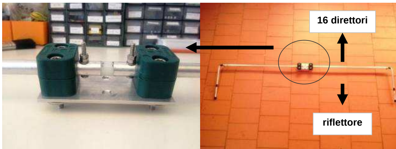
Foto 2: alcuni dettagli costruttivi, il dipolo a configurazione aperta
