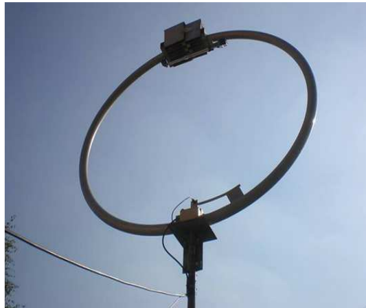
La nuova antenna di Davide, una loop di Ciro Mazzoni modello Midi , 2 mt di diametro da 3,5 a 14,5 MHz.
