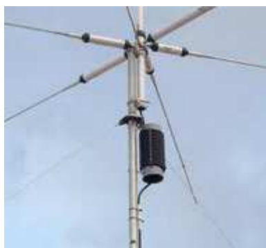
RF Choke ... 10 Kierrosta 15 cm halkaisia lenkille
