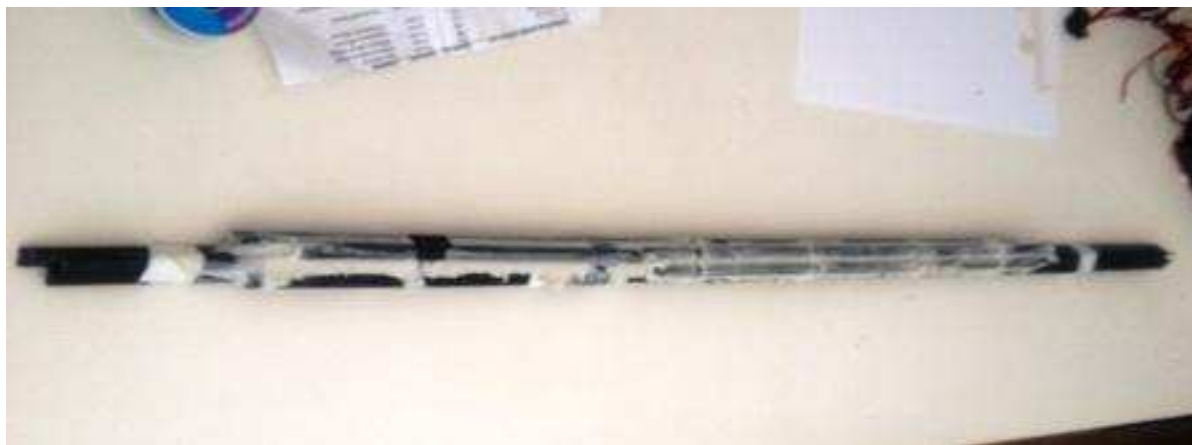
Foto 1: la "grande ferrite" da 90 cm ricoperta in buona parte dalla colla tipo "mille chiodi"
