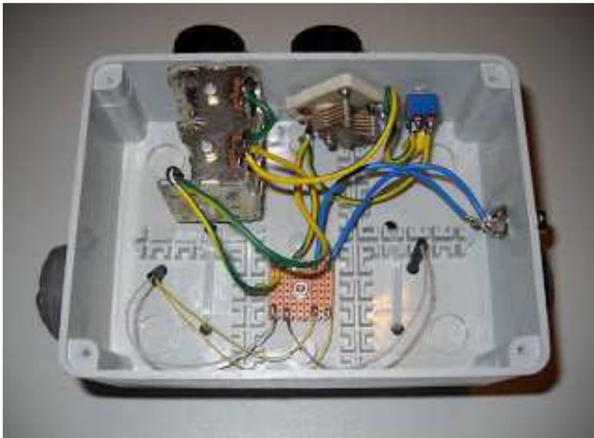
I due capi del primario sono stati poi connessi all'interno di una semplice scatola in plastica per impianti elettrici ad un comune condensatore variabile in aria per la sintonia, in parallelo con un trimmer capacitivo in **aria da 3-30 pF** (sintonia fine) e ad uno **switch** tramite il quale è possibile inserire un ulteriore condensatore fisso in polistirene da **100 pF**.
