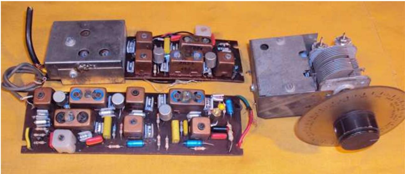
I famosi telaietti della Philips gruppo RF con transistor al germanio completo di demoltiplica utilizzati per la realizzazione di ricevitori VHF da 11PMM
