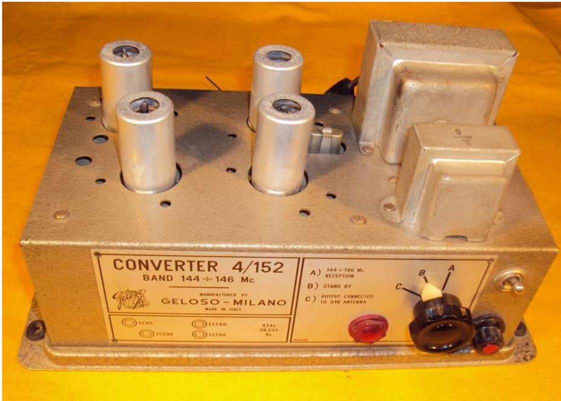
Convertitore VHF 144-146 valvolare Geloso N° 4/152 con alimentatore
