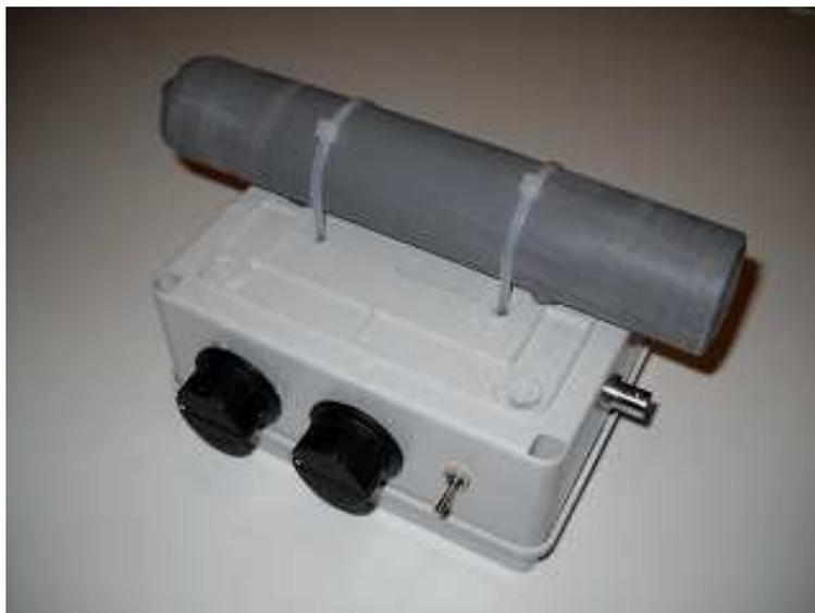
Beh non c'è molto da descrivere in questo caso. Si tratta dell'ennesimo loop su ferrite per l'ascolto delle LF (nel mio caso, soprattutto broadcast e NDB), pensato e costruito per due scopi:
