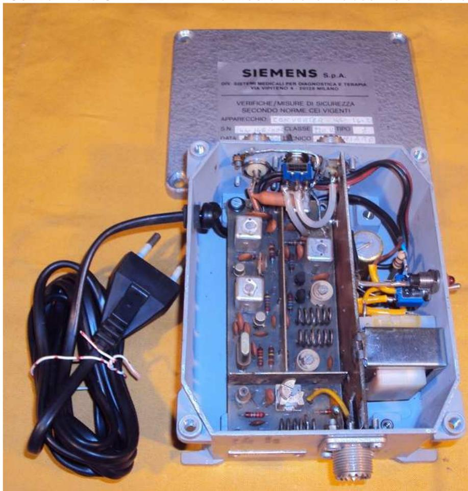
**Convertitore VHF 144-146 autocostruito con alimentatore in scatola di alluminio Siemens con un modulo di recupero della STE.**
