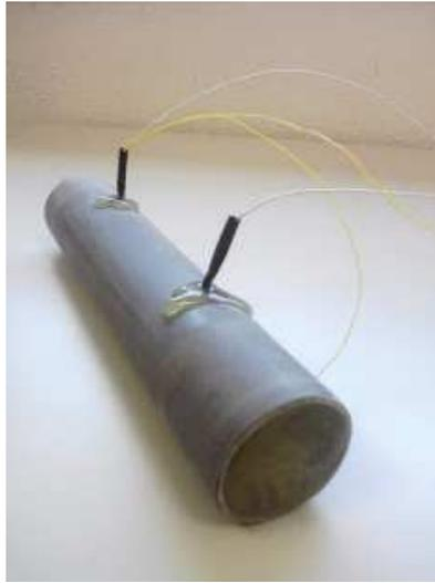
Sopra questo avvolgimento (primario), vicino ad uno degli estremi, sono state avvolte 14 spire di normale filo per wrappatura (il filo giallo che si vede nella foto), con funzioni di avvolgimento secondario. Il tutto è stato poi inserito in un tubo in PVC da 40 mm e sigillato con colla a caldo.
