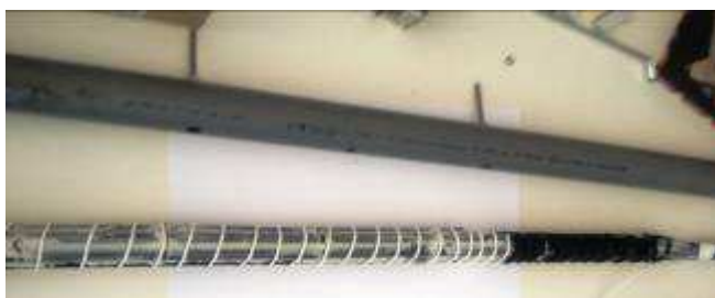
Foto 3: il tubo in plastica con le viti di fissaggio al supporto in plexiglass e l'avvolgimento del loop.
