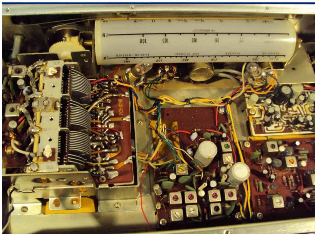
In alto il tamburo rotante posto sul frontale per le varie gamme.
