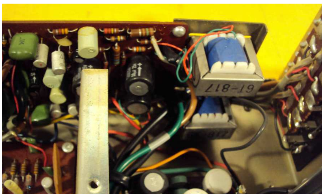
I trasformatori pilota per il pilotaggio dei transistor finali della BF
