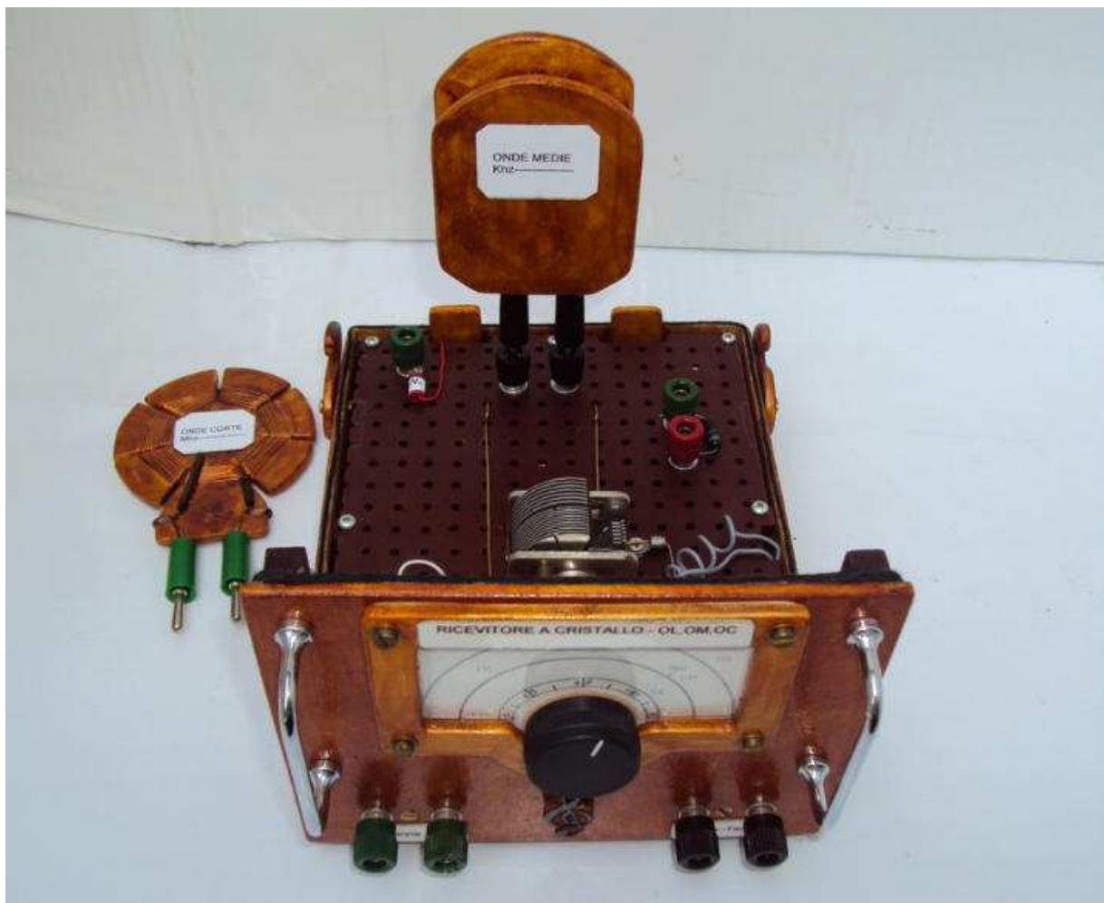
La scala parlante è stata realizzata con un Goniometro ed ho lasciato un piccolo spazio per riportare la lettura dei gradi in frequenza approssimativi, il tutto sempre collegato ad una buona antenna + Terra per un funzionamento ottimale. Il costo delle due realizzazioni sono modeste a parte il notevole lavoro ma sono state delle sperimentazioni molto interessanti i che aiutano a comprendere lo spirito Marconiano.
