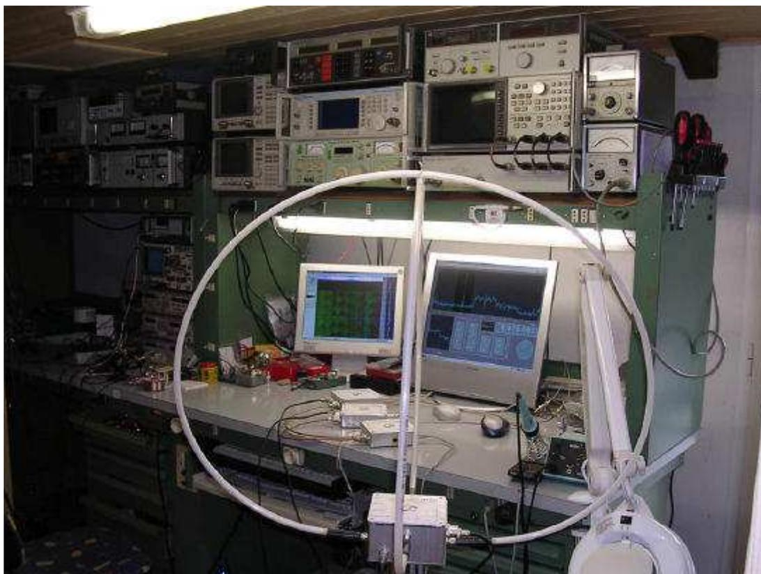
**Fig.5 : Due loop attivi L101 sfasati di 90° usati come radiogoniometro**
