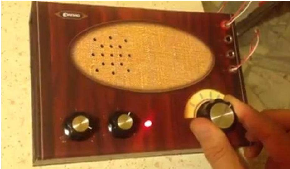
The voice of " pezzente "...ovvero la Radio di cartone del Radioamatore senza palanche....come me....ahahahah . Soli 24 euri iva compresa, spedizione dalla Germania, compresa di saldatore e stagno ,batteria da 9 volt e kit più istruzioni ! Demodula tutto ,AM,CW,SSB da 3 a 9 MHz circa, nel sito della Conrad ci sono anche altri Kit a disposizione anche a valvole.
