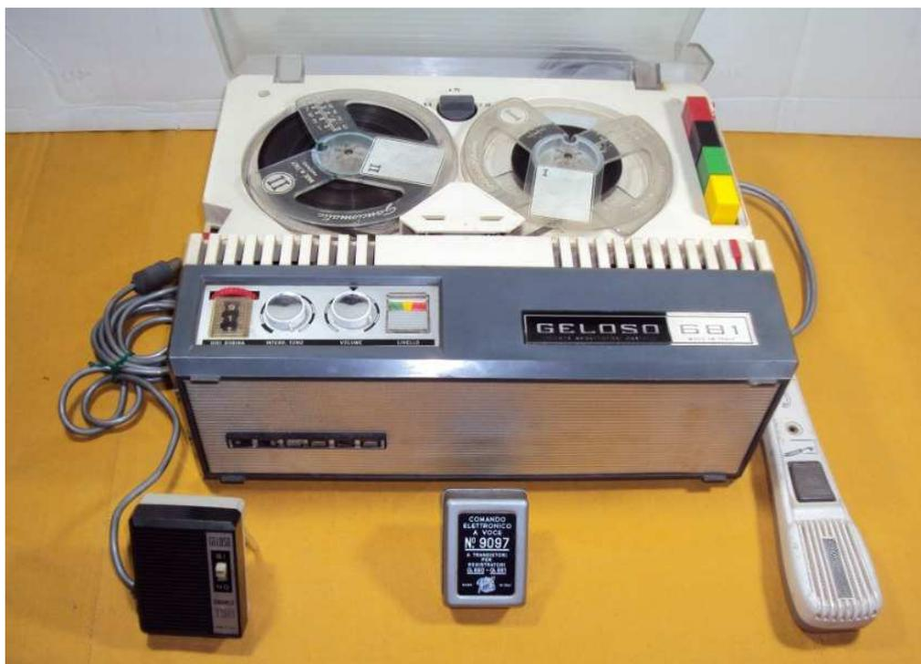
Registratore G 681 con Vocemagic N° 9097 microfono di serie M 56 e microfono t 25 con telecomando
