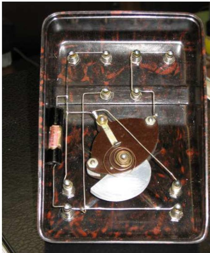
**Radio a galena in bachelite marrone VAM** con bobina a nido d'ape si vede all'interno della VAM il variabile di sintonia ed il condensatore a carta.
