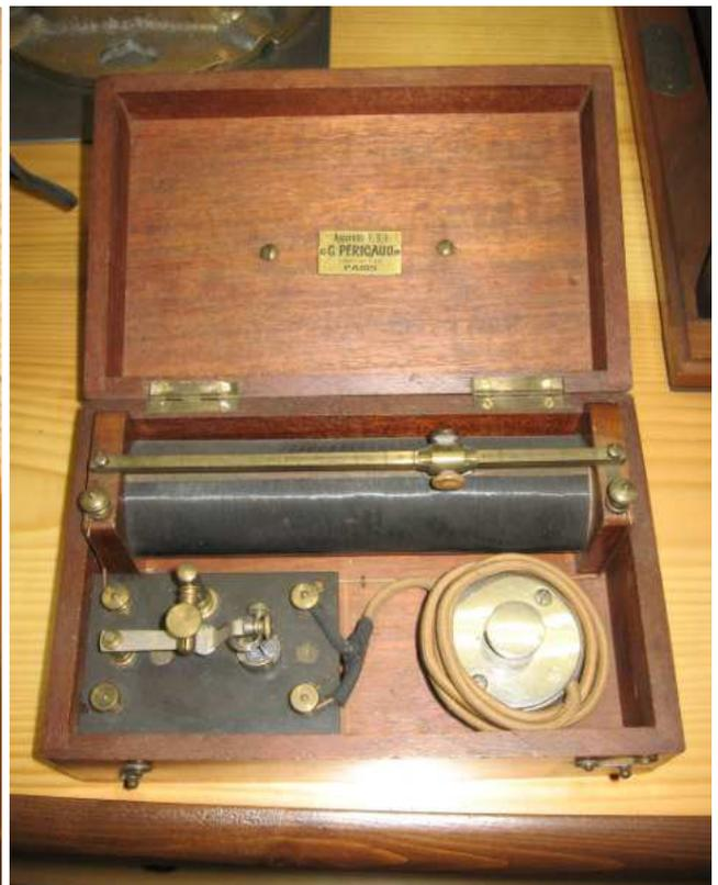
Il successo delle Radio a Galena fu dovuto al basso costo rispetto alle prime radio industriali degli anni 20 , alla estrema semplicità costruttiva ed al fatto che non serve alcuna batteria, la Radio si autoalimenta con la rettificazione del segnale ricevuto , necessita solo di antenna, terra e di un buon paio di cuffie ad alta impedenza o piezoelettriche.
