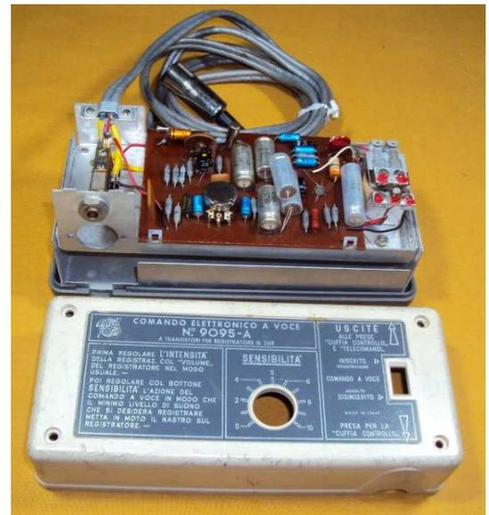
Primo Vocemagic N° 9095-A per registratore G 268 e circuito transistorizzato a vista
