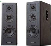
Per ottenere l'intera gamma delle frequenze audio per la riproduzione musicale HI FI si utilizzano altoparlanti di **diverse caratteristiche a seconda delle frequenze** da riprodurre. Ad ogni altoparlante vengono inviate solo le frequenze che è in grado di riprodurre mediante l'utilizzo di filtri LC detti **crossover**.
