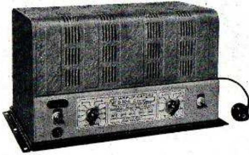
Der Kraftverstärker G-30-A ist eine Weiterentwicklung des bekannten G-27-A. Der G-30-A liefert eine Ausgangsleistung von 30 Watt bei einem Klirrfaktor von weniger als 5%. Die max. Leistung des Apparates wird mit 9 mV Eingangsspannung erreicht.
