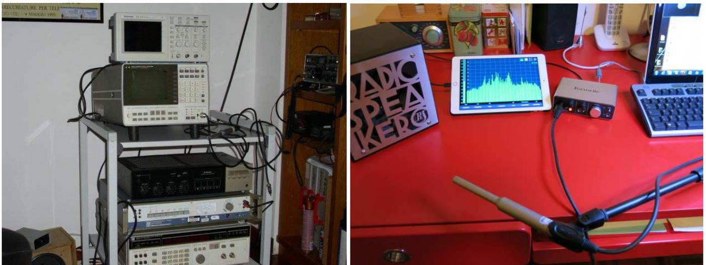
Per fare delle prove a casa utilizzo un analizzatore di spettro FFT per BF della HP, un generatore di livello sinusoidale ed un generatore di rumore bianco. Successivamente sono passato alle misure con il computer. Il microfono viene collegato alla macchina per mezzo di una scheda Focusrite direttamente ad una presa USB.
