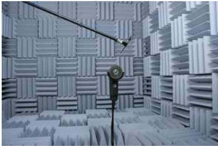
Le misure sul comportamento degli altoparlanti vengono fatte in camera anecoica, una stanza completamente isolata dai rumori e senza echi (oltre a microfoni con risposta lineare si usano dei rilevatori a laser per analizzare le vibrazioni su diverse parti del cono)
