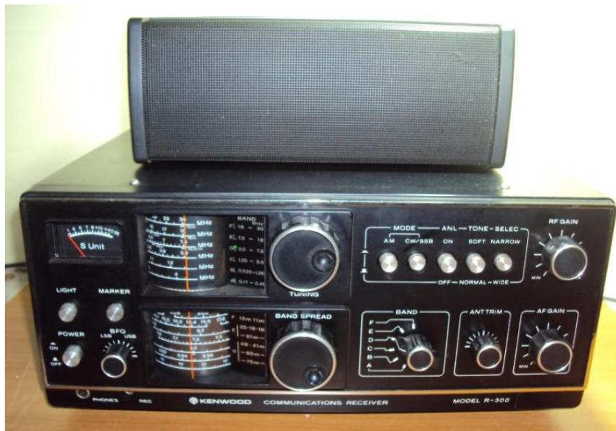
ricevitore dotato di altoparlante esterno.
