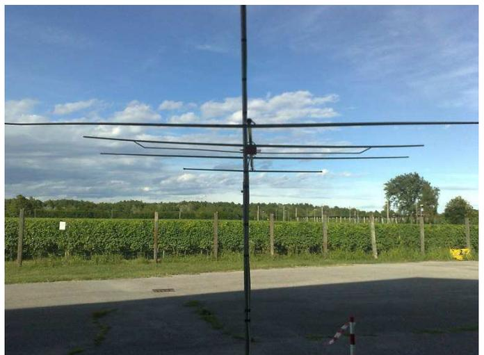
L'antenna da due elementi posizionata in un terrazzino e quella di quattro posizionata a 02,50 mt. da terra fanno da "supporto morale" all'antenna **big-seven**. Entrambe della Fracarro, esse operano in banda fm giusto per completare l'attività ricettiva in gamma OIRT (sistema televisivo medio-orientale).
