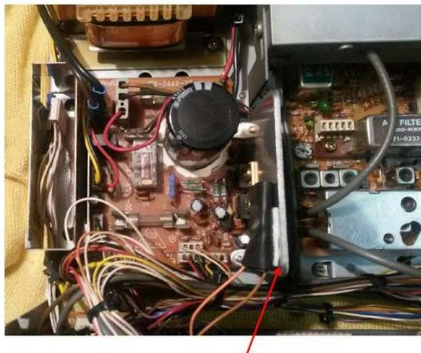
batteria fissata con nastro biadesivo
