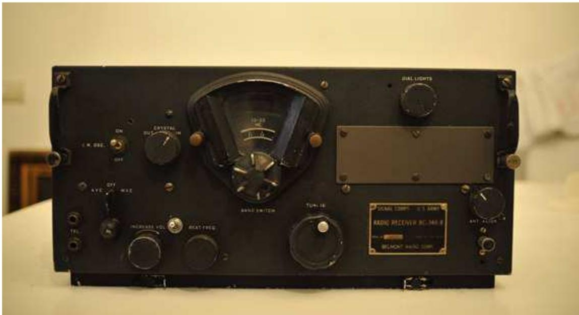
Il design di base del BC-348 è molto intelligente; la frequenza intermedia è di ben 915 kHz.
