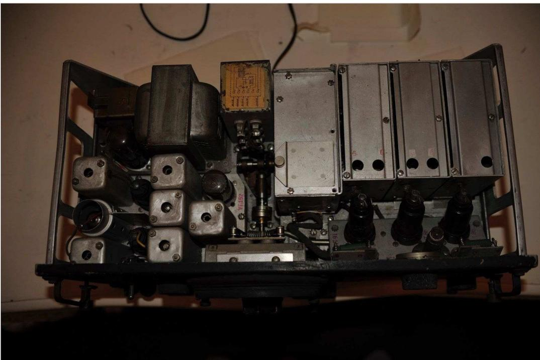
Ogni scatola contiene un commutatore a wafer accoppiato a quelli nelle altre scatole adiacenti con un meccanismo ad asta passante. In teoria, questo permette alle scatole di essere rimosse e/o sostituite singolarmente (non senza difficoltà..), ma di certo conferisce al ricevitore una configurazione azzeccata e una realizzazione eccellente.
