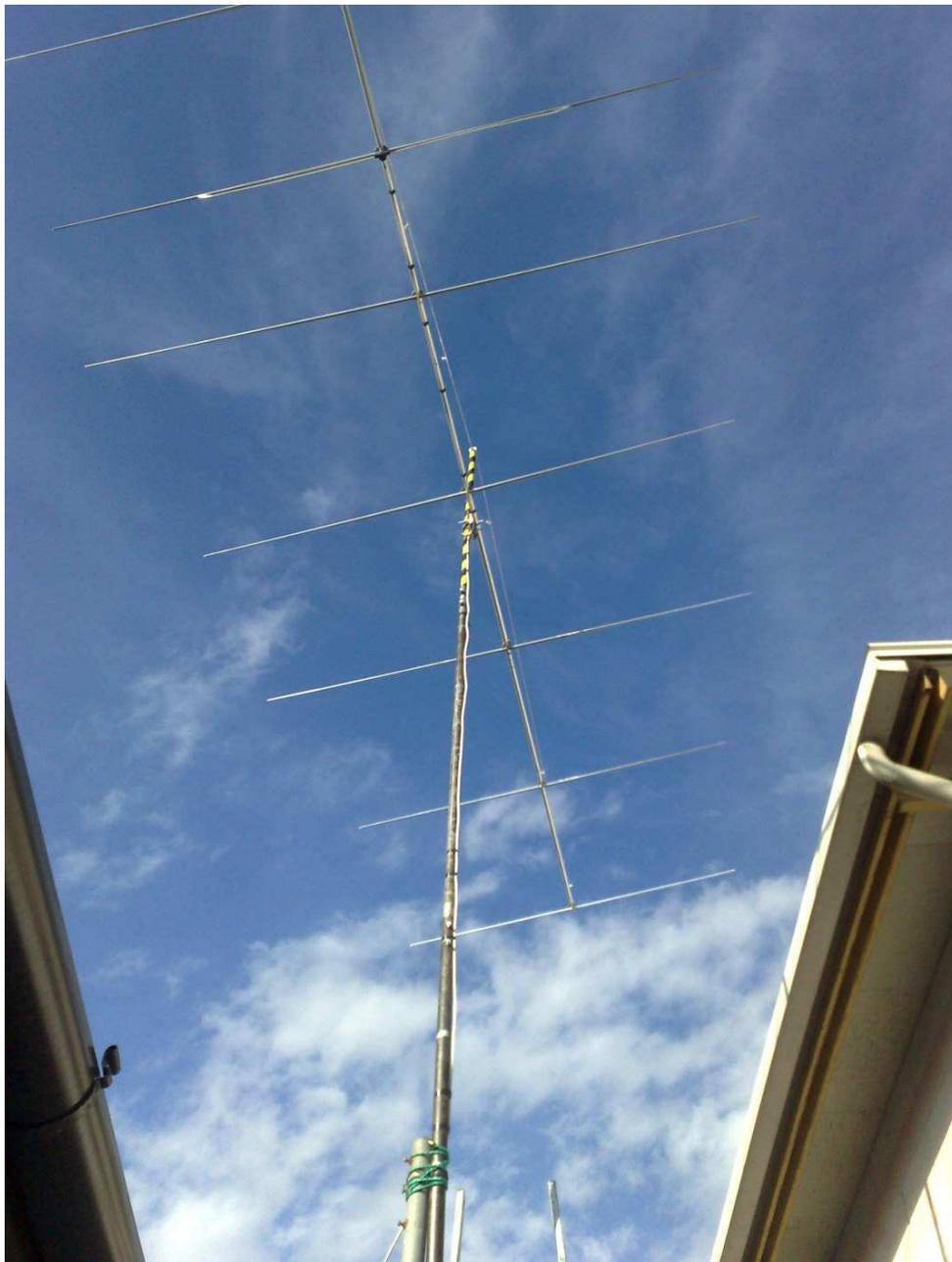
L'antenna a sette elementi per il canale A Vhf
