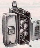
**SOSTITUZIONE PILE** - Occorrono 8 pile da 1,5 Volt, diametro 26 mm, lunghezza 50 mm, tipo «torcia». Svitare le due viti godronate laterali (vedi figura) e sfilare la cassetta contenente uno dei due altoparlanti. Svitare le altre due viti sul compartimento pile e togliere il coperchio. Inserire le pile come indicato sul coperchio, alternativamente una diritta ed una rovesciata. In caso di errato inserimento delle pile l'«Amplibox» non funzionerà, ma non ne deriverà alcun danno all'apparecchio.
