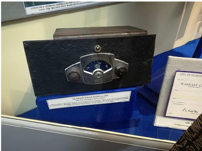
*Questo particolare apparecchio per autovetture venne costruito nel 1936 circa dalla EKCO espressamente per la Polizia di Glasgow. Poteva solo ricevere dei messaggi trasmessi dalla centrale operativa, eventuali risposte potevano essere solo trasmesse in codice morse oppure telefonicamente per mezzo della prima cabina telefonica della polizia disponibile.*
