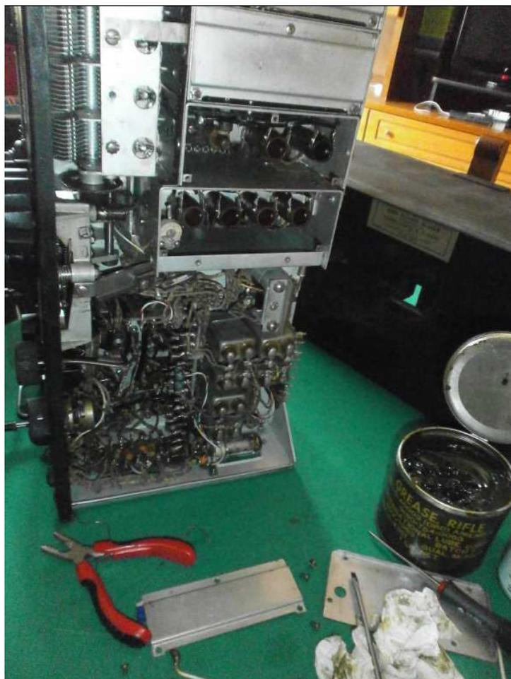
Una volta accertato che non ci fossero altri lavori imminenti, sono passato al controllo di efficienza di tutte le valvole, trovando la VT-93 (6B8) un pochino esaurita. Come strumento ho usato il mio EICO 625 Tube Tester. La 6B8 l'ho sostituita con una NOS (New Old Stock) e ho provveduto a togliere la PCF 80 adattata a 6F7 sostituendola con una originale 6F7B americana, sempre NOS.
