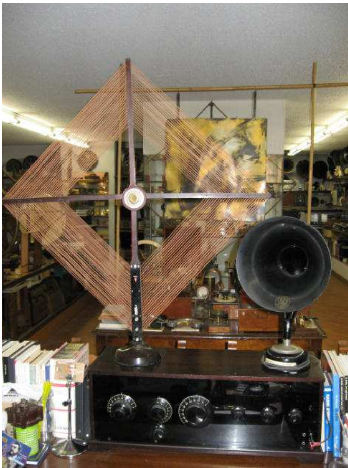
Esemplare Baltic con ergonomia comandi differente da Baltic 20 - Antenna a telaio Baltic.
