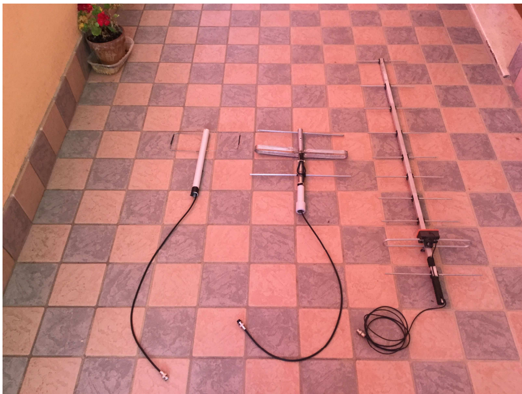
Figura 1: tre modelli di antenne direttive per la caccia alle RS.
