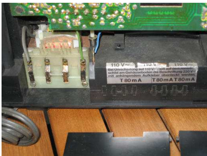
porta fusibile che funge anche da cambio tensione Comandi a slider volume, toni alti e toni bassi.
