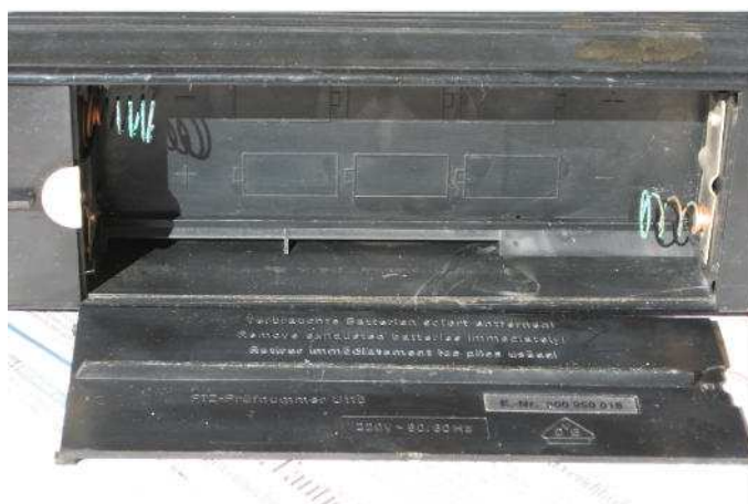
particolare del vano batterie con molle di contatto molto ossidate.
