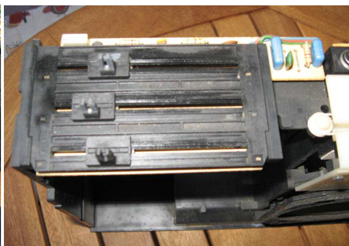
porta fusibile che funge anche da cambio tensione Comandi a slider volume, toni alti e toni bassi.
