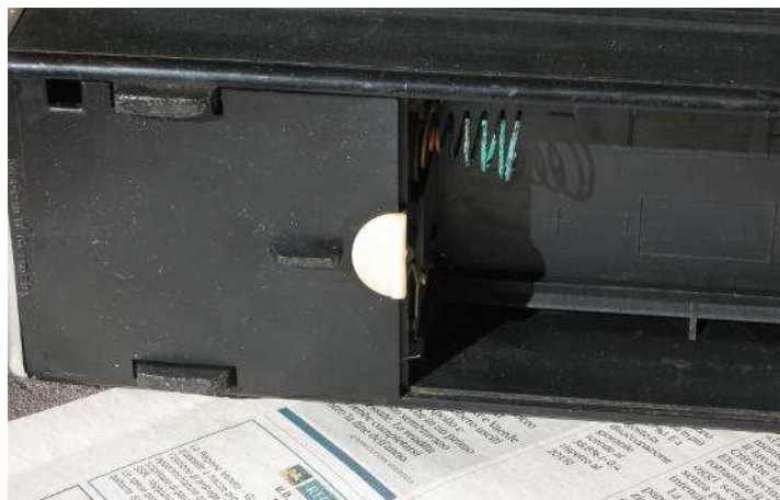
particolare del vano batterie con molle di contatto molto ossidate.
