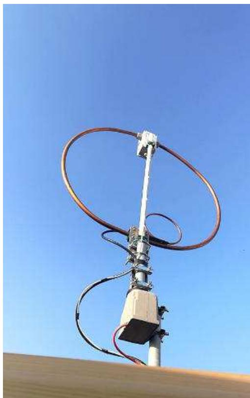
Il progetto da cui sono partito, reperito su internet è quello della loop progettata e realizzata da **Enzo I6VMS**, Il tubo in rame l'ho reperito da un idraulico, ho utilizzato quello in matasse così da avere una forma già rotondeggiante.
