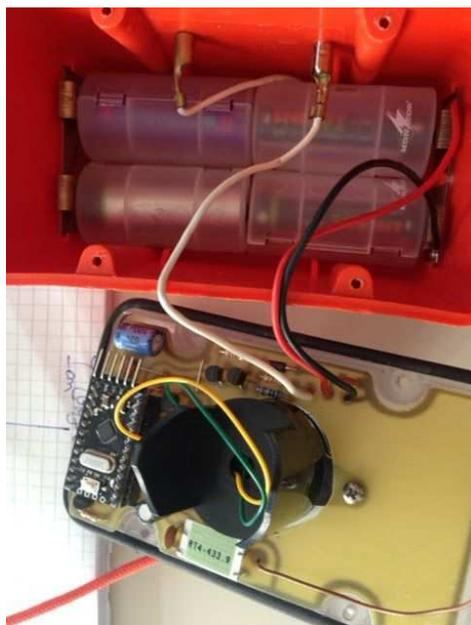
Figura 4. il vano batterie e la nuova scheda programmata
