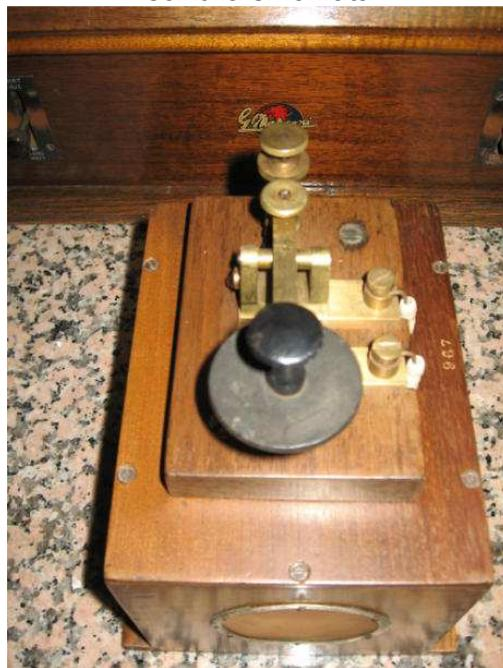
telegrafo originale installato su biplano francese Spad modulazione a scintilla smorzata,alimentazione a dinamo con elica,antenna filare a caduta avvolta su naspo dedicato.
