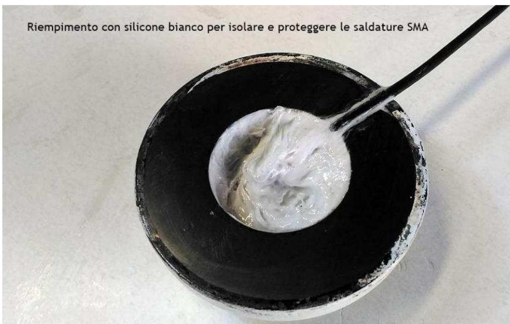
Riempimento con silicone bianco per isolare e proteggere le saldature SMA
