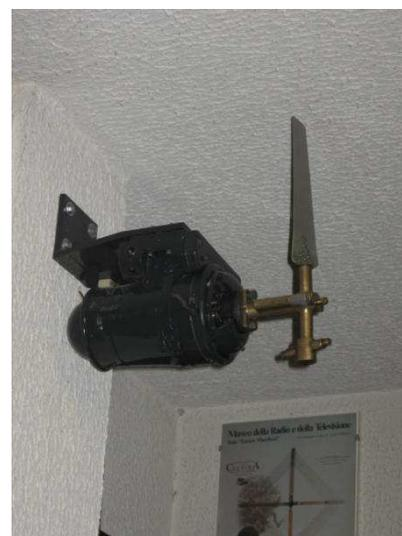
naspo originale di avvolgimento antenna a caduta montato e dinamo originale montata su biplano Spad
