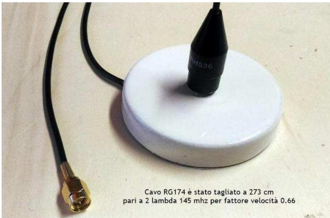
Questo tipo di base è praticamente introvabile in commercio con SMA Femmina + RG174 con SMA maschio e mi consentirà di provare vari tipi di gommini/ piccole antenne bibanda con attacco SMA.
