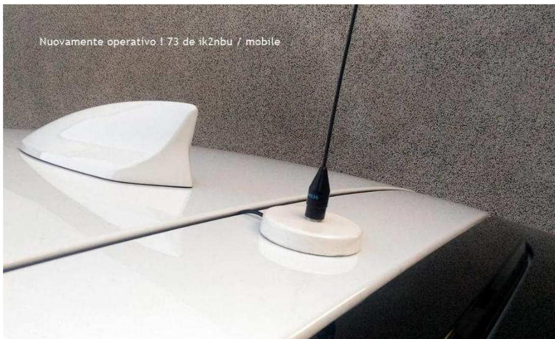
La base magnetica l'ho ricavata da una diamond che ho modificato in modo da avere attacco SMA per antenna VHF-UHF, e con cavo piccolo RG174 che era unico che passava dal portellone ! Non volevo usare una micromag perchè durano poco, ma qualcosa di + serio senza esagerare con dimensioni ed ingombri antenna, allego le foto da 1 a 6 della ricostruzione della base magnetica 6 cm.
