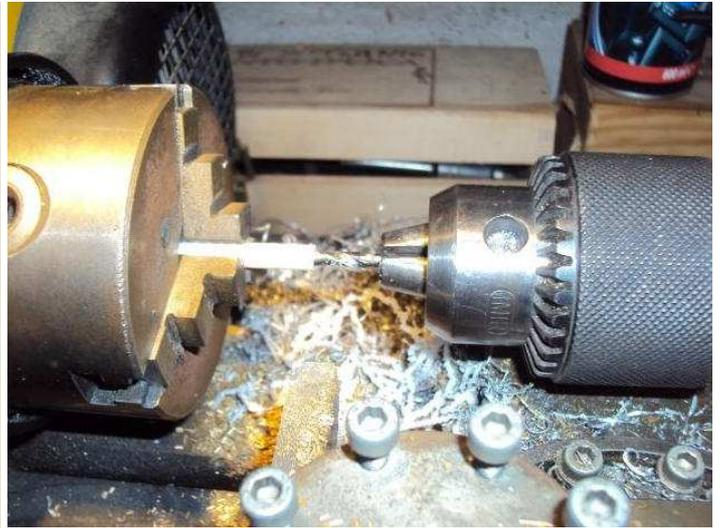
**Potenzimetri in cui ho recuperato i perni in nylon - la realizzazione degli adattatori al tornio per i potenziometri con perno da 4mm**
