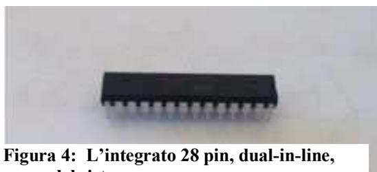
Figura 4: L'integrato 28 pin, dual-in-line, cuore del sistema.
