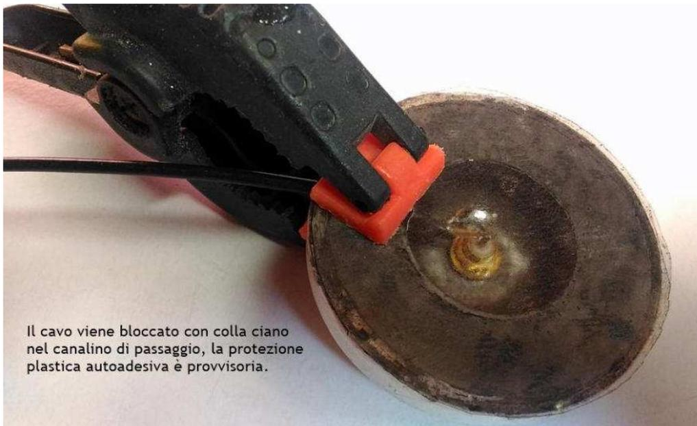
Il cavo viene bloccato con colla ciano nel canalino di passaggio, la protezione plastica autoadesiva è provvisoria.
