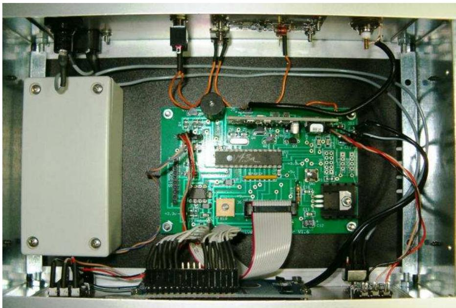
Figura 8 –Interno del controller (vista dall'alto).Sulla sinistra è visibile l'alimentatore di rete 230VAC-12VDC
