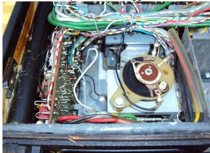
Particolare del potenziometro della sintonia FM a Varicap
