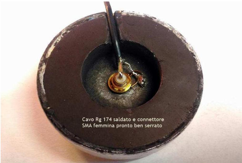
Cavo Rg 174 saldato e connettore SMA femmina pronto ben serrato
