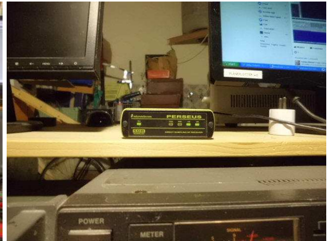
Perseus per le HF con antenna windom da 25 mt
