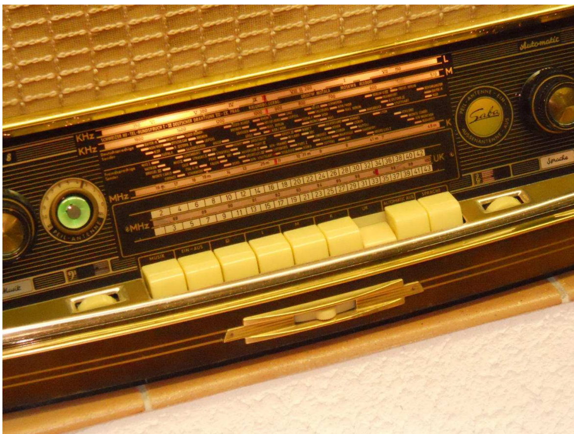
SABA Freiburg Voll Automatic (valvole impiegate : serie europa miniatura) panoramica della grande scala parlante con occhio magico e primo piano della lussuosa tastiera color avorio con i comandi laterali di alti e bassi l'insieme è realmente un oggetto raro e prezioso
