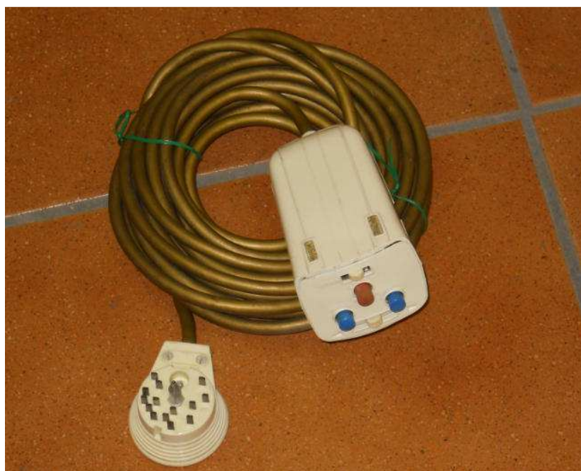
Il famoso e innovativo Telecomando per le SABA Voll Automatic, notare i pulsanti e la presa multipoli.
