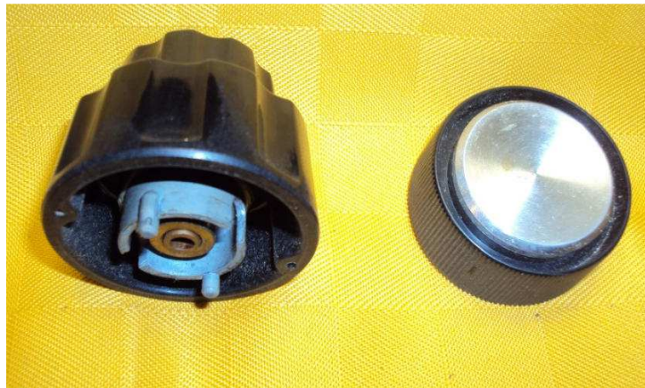
Le due manopole l'originale e la demoltiplica applicabile con due piccoli fori invisibili
