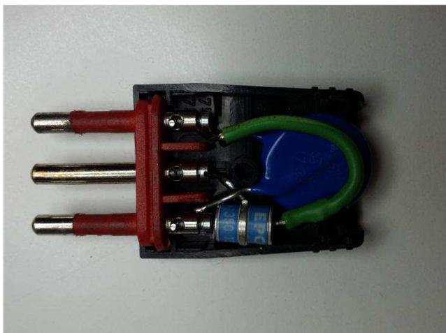
Veramente piccola e pratica questa mia idea di realizzare un SPD di TIPO 3 con TRANSIL su spina. Nella foto manca il diodo soppressore TRANSIL aggiunto successivamente collegato tra Fase e Neutro. Per utilizzare in modo corretto la Protezione di TIPO 3, così realizzata, basta collegare ad una presa di corrente la presa tripla ed in parallelo si collega l'apparecchiatura da proteggere.
