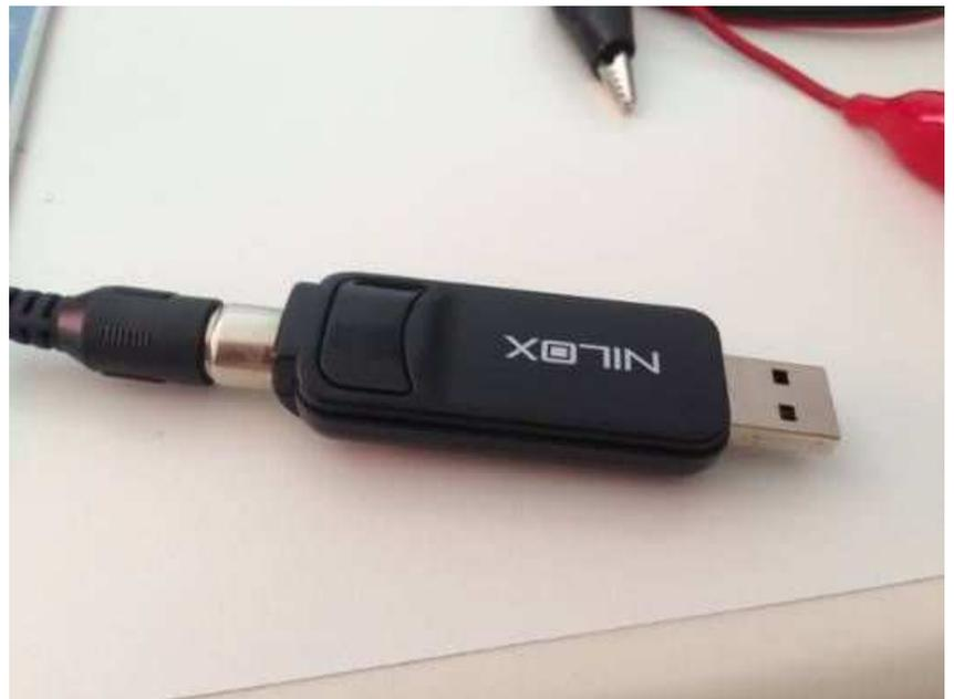
Figura 2: ricevitore SDR per l'ascolto delle radiosonde;
