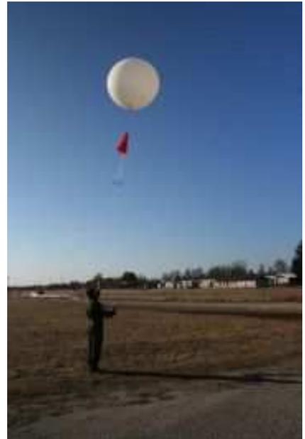
Figura 1: rilascio manuale di radiosonda;
