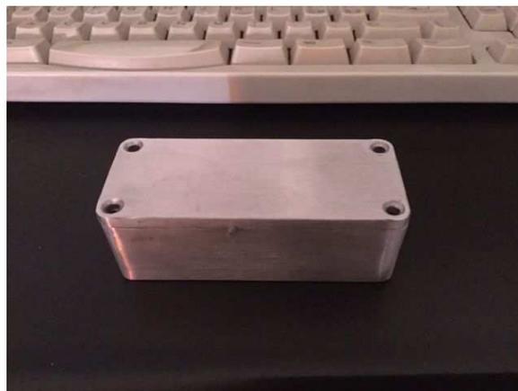
**Figura 4: Il contenitore in alluminio per il montaggio del preamplificatore.**
