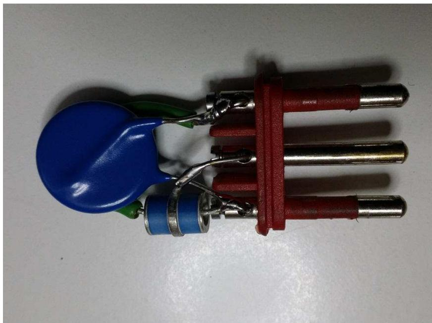
Scaricatore di Sovratensioni di TIPO 3 in una semplice spina elettrica è visibile il doppio spinterometro e il grande varistore. Nella foto manca il diodo soppressore TRANSIL aggiunto successivamente collegato tra Fase e Neutro.
