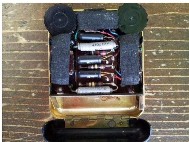
Apparecchio aperto si nota il circuito con i tre transistor ed i due elettrolitici di accoppiamento
