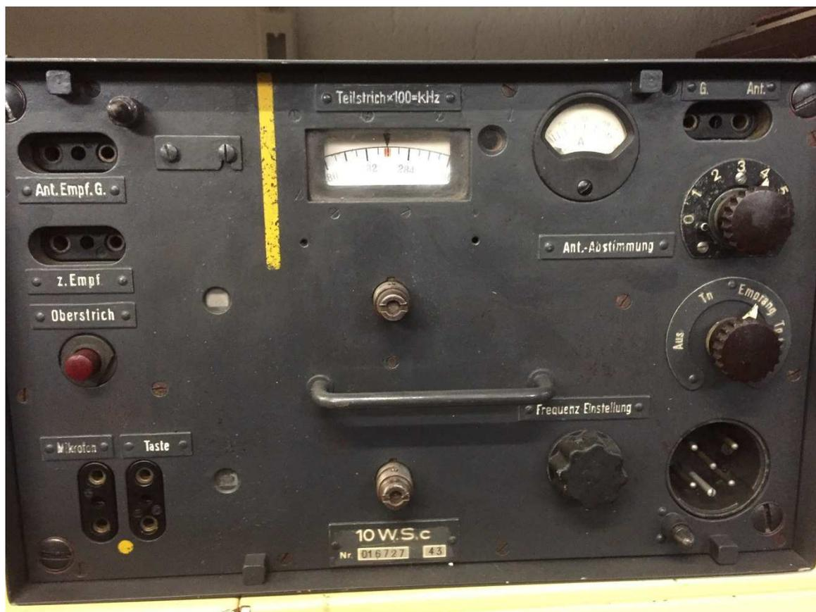
Primo piano del TX 10W S.c in versione riga gialla, ovvero predisposto in coppia con RX UKW E.e per la funzione di interfono tra il Comandante, Carrista e Radio Operatore
