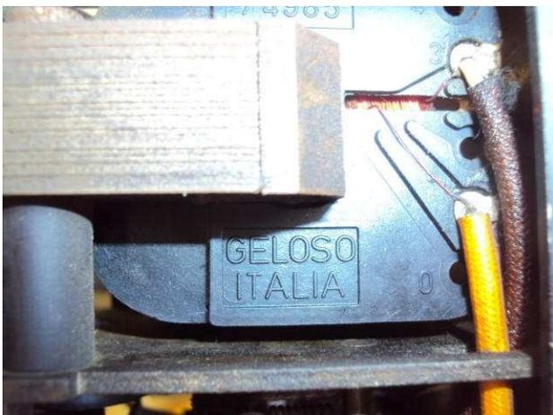
Motore per trascinamento carta di produzione Geloso completo di riduttore .
