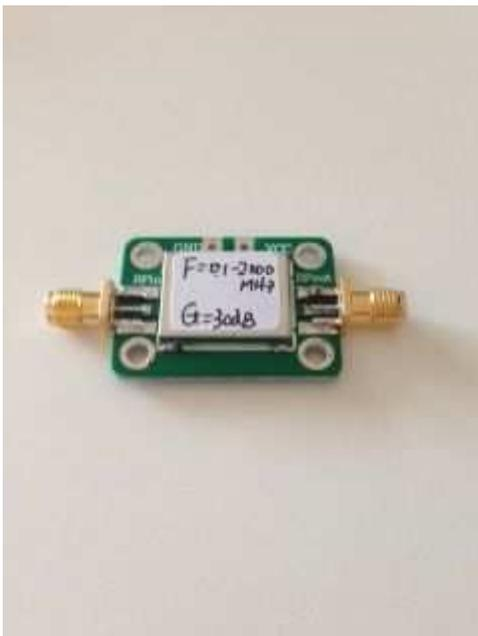
Figura 3: Il modulo preamplificatore;
