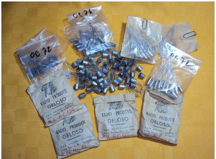
campionatura di transistor Philips utilizzati per il circuito dell'Uditofono
