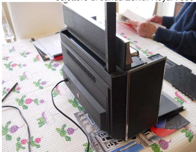
parte posteriore della Zenith Royal 7000 con vano porta pile e cavo di alimentazione in AC
