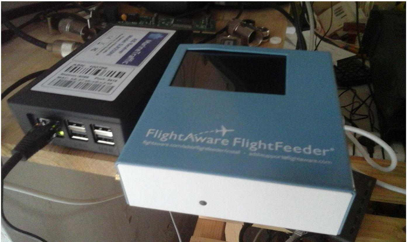
**FlightAware**, progetta e produce “Flightfeeder” una rete di ricevitori ads-b che riceve dati Ads-b dagli aeromobili e li trasmette ai server di FlightAware.com attraverso Internet.
