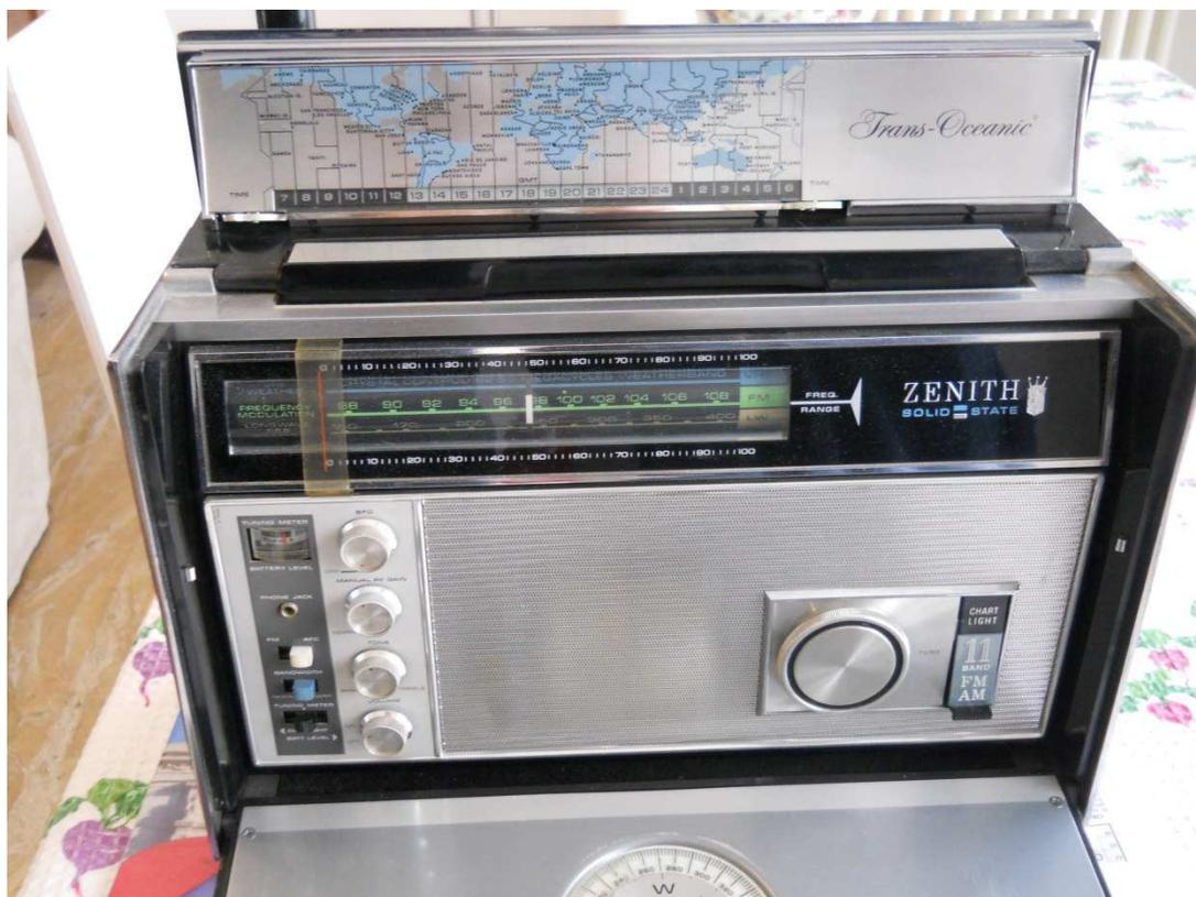
Primo piano Zenith Royal 7000, notare la scala rotante delle frequenze con colori diversi per gamma
