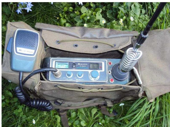
**In evidenza il microfono e la molla della antenna**
