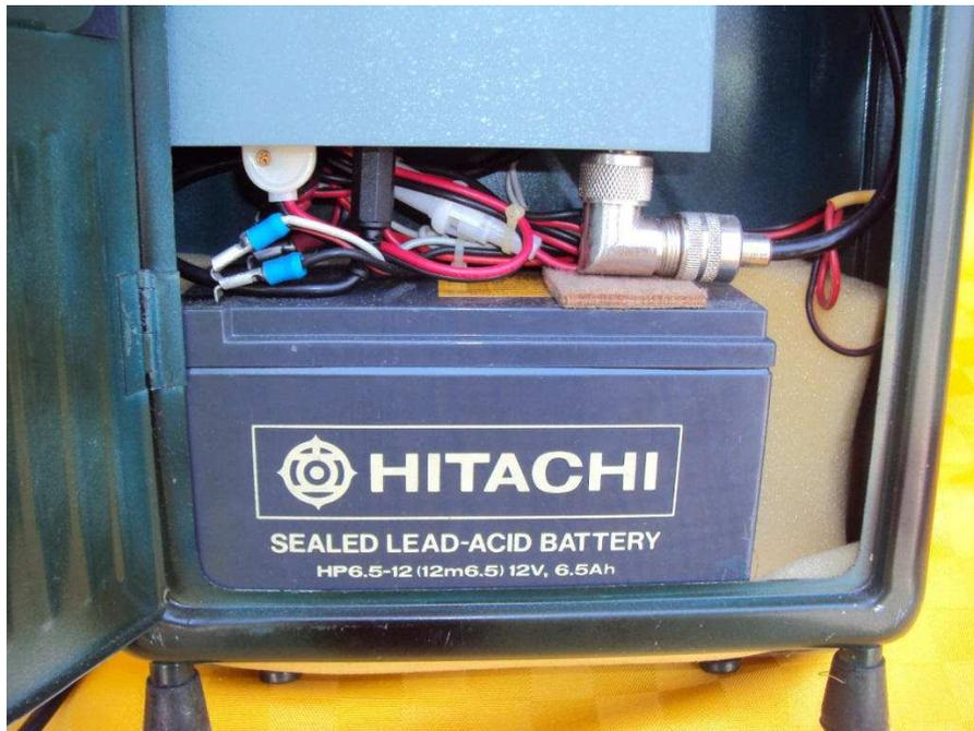
**RTX Alan 44 particolare della batteria ed il connettore d'antenna**
