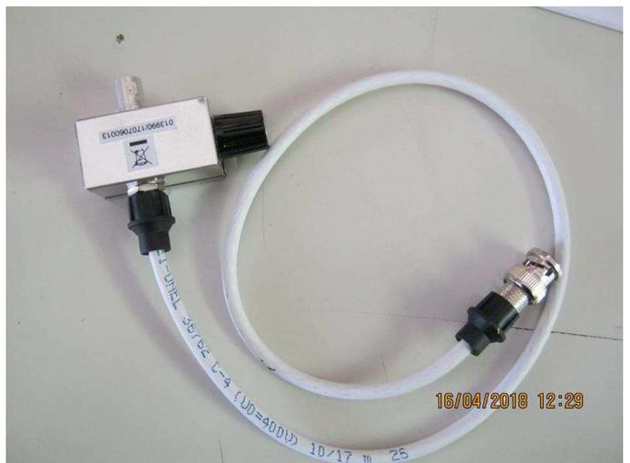
L'attenuatore è collegato al SDRplay1 con un cavetto antenna con connettore F e BNC/F.
