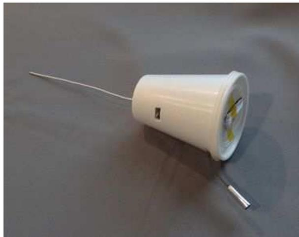
Figura 3: Radiosonda S1 di Windsond
