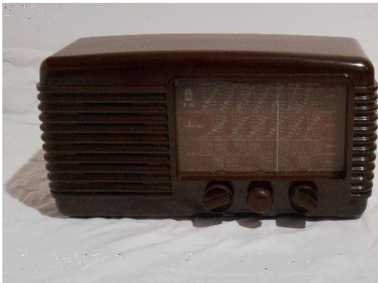
dimensioni sono circa 38 x 21 x 16 centimetri ed il suo mobiletto è in materiale plastico marrone con forme arrotondate. L'impostazione del mobile è piuttosto consueta con altoparlante sulla parte sinistra del medesimo e alla destra un'ampia scala parlante in vetro di forma rettangolare; sotto alla scala trovano posto partendo dalla sinistra il controllo di volume con annesso interruttore di accensione, la manopola di sintonia e la manopola di cambio gamma di ricezione. L'apparecchio
