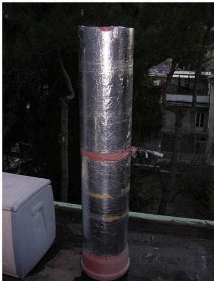
Allego anche la foto della versione definitiva del sistema molto stabile usando come supporto per il dipolo molto ciccione in questo caso un tubo da scarico acque di grande diametro ( 40 cm ) che ho rivestito di pellicola di alluminio incollata con colla Bostik .
