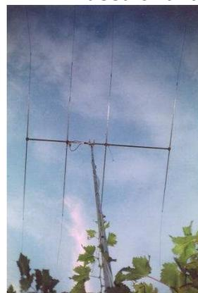
Antenne con dipolo incrociato ( di prova) con 4 elementi orizzontali e due verticali.
