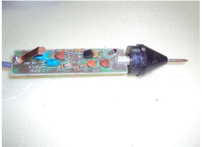
sonda attiva dopo aver sostituito vari condensator mancanti
