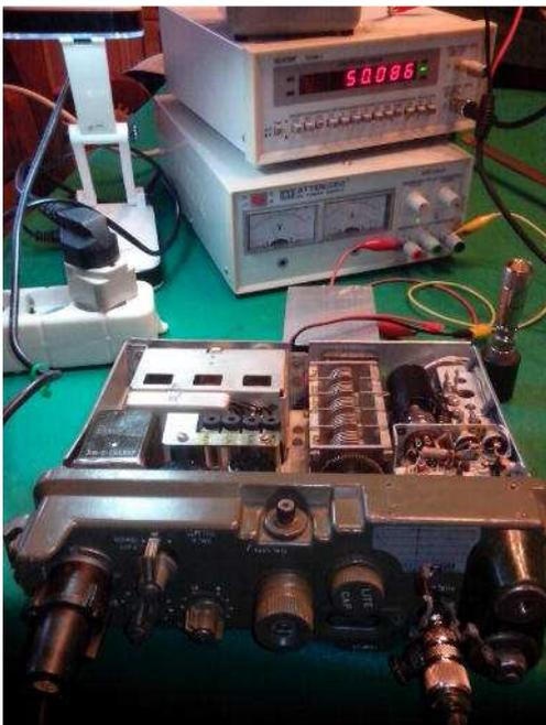
Sul web sono reperibili anche dei Tube Set da usare per la sostituzione delle piccole valvole Raytheon. Il manuale della PRC-10A, che ricordo essere piuttosto differente dalla prima versione PRC-10, non è facilmente reperibile in rete. Ho però trovato il sito di **JH3FJA** nel quale è possibile scaricarlo in formato PDF. Il manuale di riferimento è il **TM-11-4065A**.
