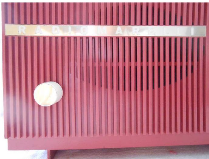
**Griglia dell'altoparlante con fregio Radiomarelli ed interruttore con abbinato controllo di volume.**
