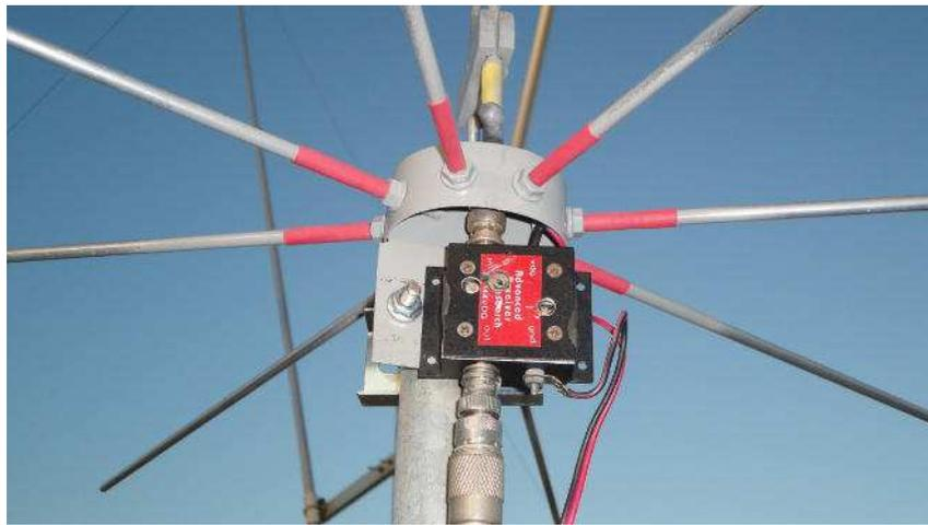
Fig. 6 particolare base antenna e preamplificatore
