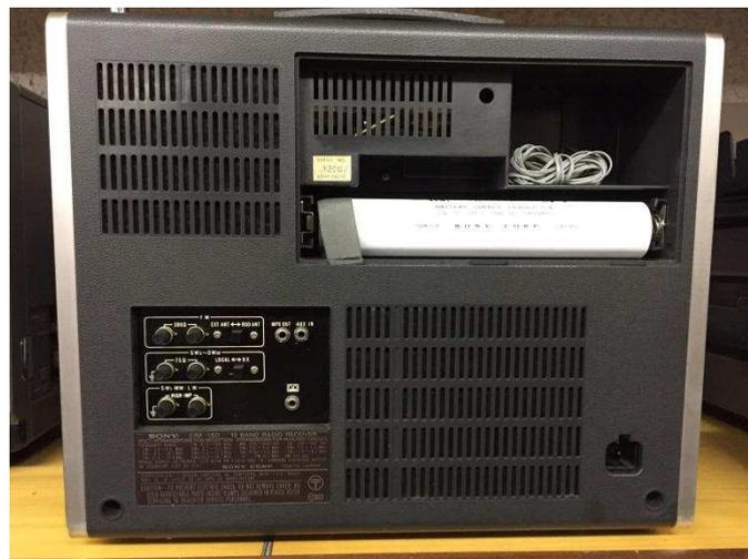
Lato posteriore con vano porta batterie in alto, varie prese per antenna ed uscite ausiliarie notare in basso la presa per cavo di alimentazione, a destra con vano porta batterie aperto
