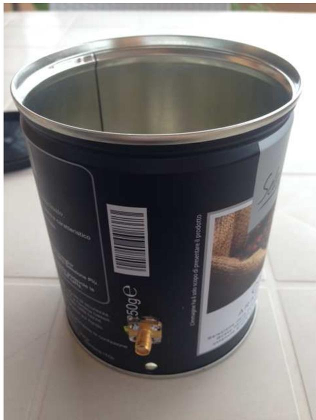
Figura 2: antenna a barattolo con connettore SMA
