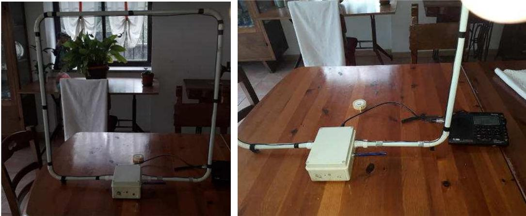
All'interno del tubo ho passato uno spezzone di cavo 75 schermato x tv così facendo ho creato 2 spire che vanno sul variabile ad aria 400 pf +400pf il condensatore lavora in serie così si ottiene 200pf e così facendo non si ha "l'effetto mano" quando aggiusti la frequenza di risonanza un link esterno al tubo va sul bocchettone, dimensione del loop 70cmx 70cm.
