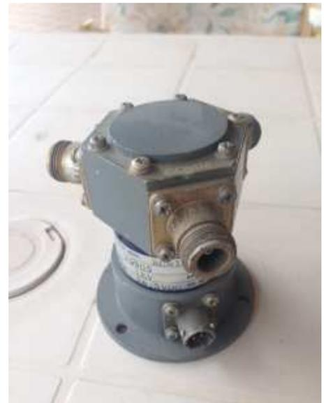
Figura 4: Selettore professionale SPDT per microonde. Connettori N.
