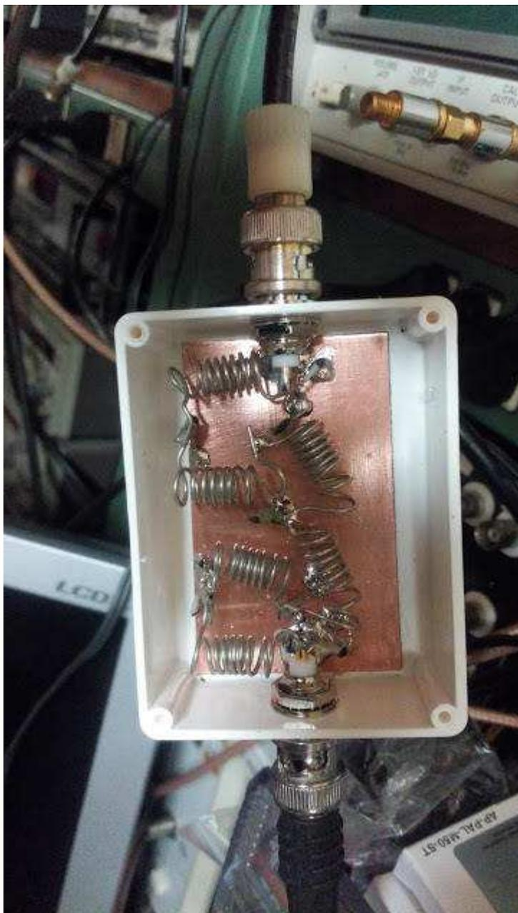
Il filtro realizzato ed ottimizzato allargando e stringendo le bobine
