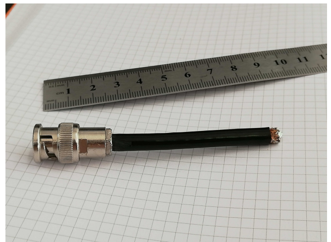
Figura 4: filtro per la gamma radiosonde.
