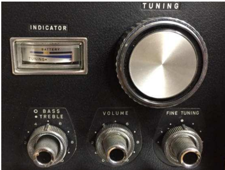
Primo piano dei comandi principali e strumento S.Meter/Batterie
