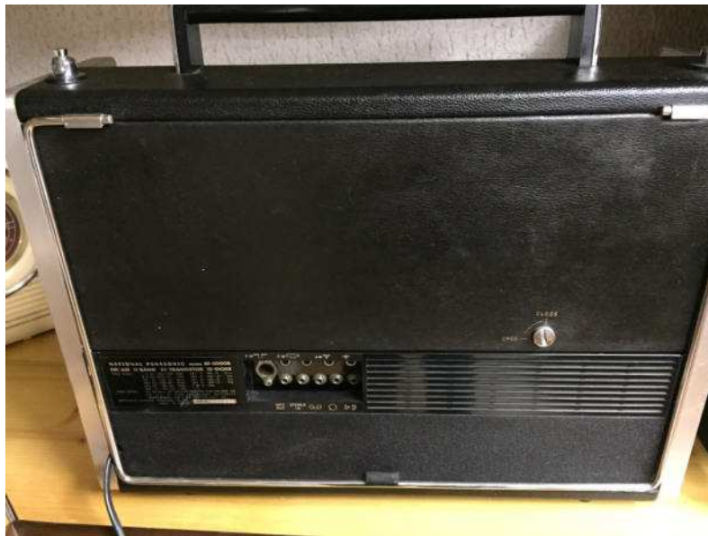
Parte posteriore Panasonic RF 5000 con prese per antenne esterne AM-FM e uscite varie, si nota l'antenna a quadro ripiegata.
