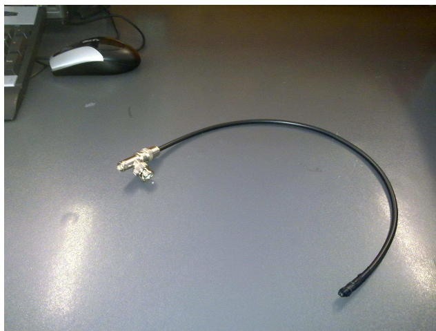
Figura 2: il “T” con connettori BNC, per una facile operazione di aggancio/sgancio.
