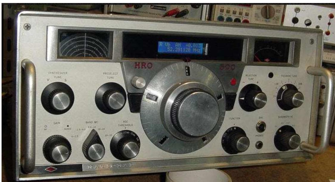
Il ricevitore HRO500 fa parte della prima generazione di ricevitori professionali transistorizzati, difatti utilizza gli ormai superati transistor al germanio. La caratteristica interessante è che non utilizza circuiti stampati, tutto il circuito è cablo come un valvolare, i transistor sono fissati al telaio a mezzo zoccolati.
