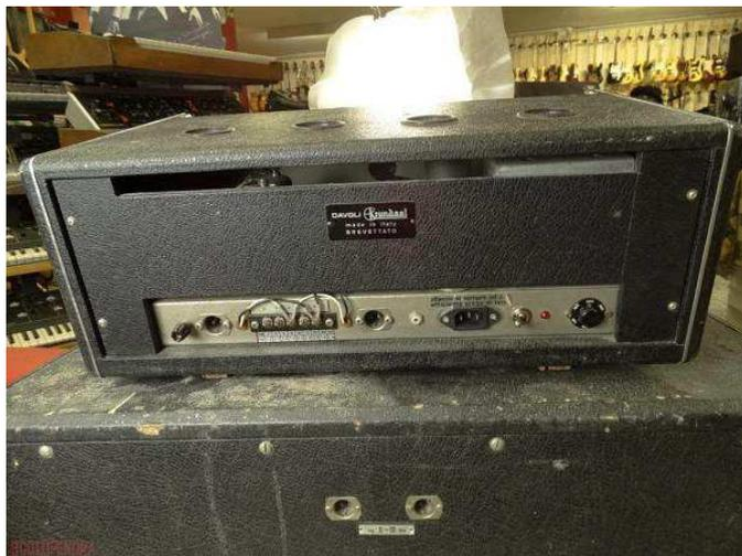
**Amplificatore Davoli con uscita altoparlanti con spine Geloso - Amplificatore Lombardi con connettori Geloso**
