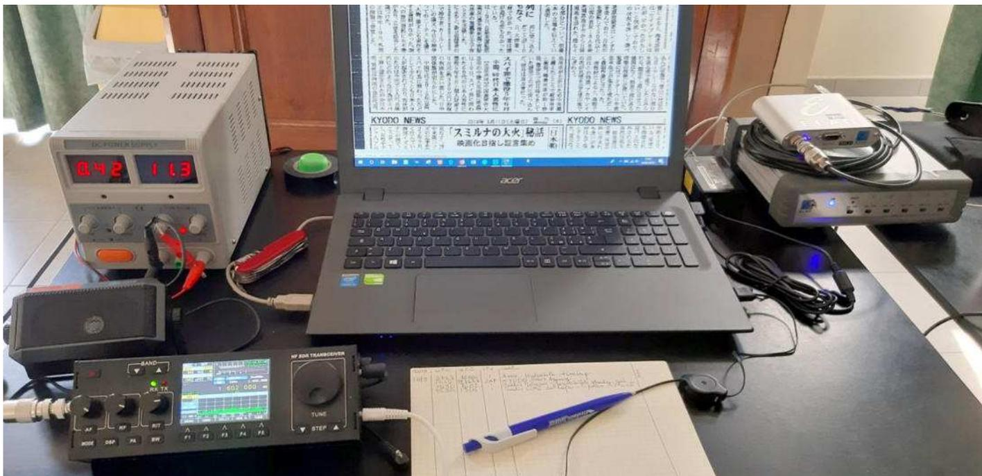
Dimenticavo... anche quest'anno, memori di discutibili alimentatori più o meno switching fonti di ogni sorta di rumore ad RF, ho portato un alimentatore da laboratorio, pesantuccio, ma ottimo alleato per tenere distante il rumore dai nostri delicati strumenti.
