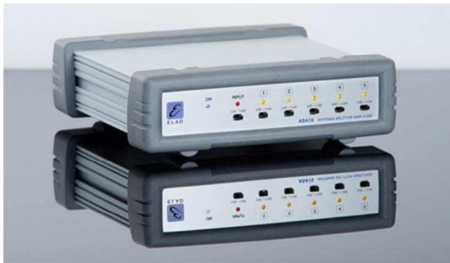
Insostituibile compagno di tanti anni di attività sul campo è stato l'**ASA-15** antenna splitter della famosa ditta italiana Elad, capace di un ingresso e 5 uscite, ognuna con guadagno individuale di 12 dB ed attenuatore generale di 15 dB. La sua presenza è stata messa in forse da una manovra sbagliata occorsa nel mio QTH. Spedito in quel di Caneva (PN), è stato prontamente riparato e restituito nell'arco di una settimana.
