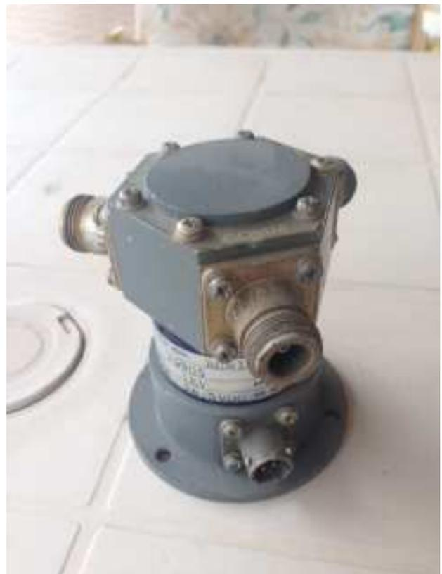
Figura 1: relay coassiale professionale, 1 via/2 posizioni, alimentabile a 24 volt e con frequenze di lavoro dalla Dc a qualche GHz.
