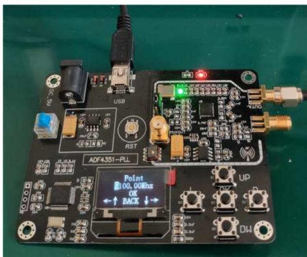
**Modulo di generazione del segnale Geekcreit® 35M-4.4GHz Scheda di sviluppo del sintetizzatore di frequenza sorgente del segnale RF ADF4351.**
