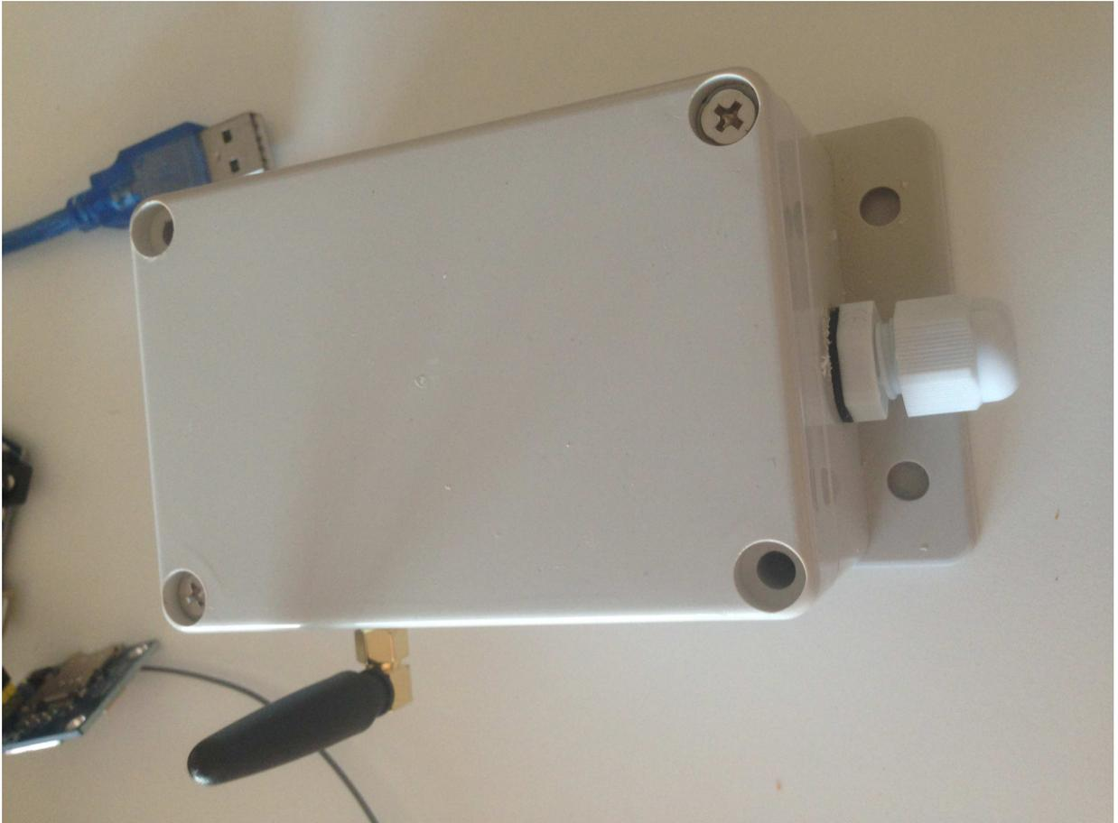
**Figura 3: vista d'insieme del dispositivo GSM di controllo; a sinistra è visibile una delle piccole schede GSM utilizzate nelle prove;**
