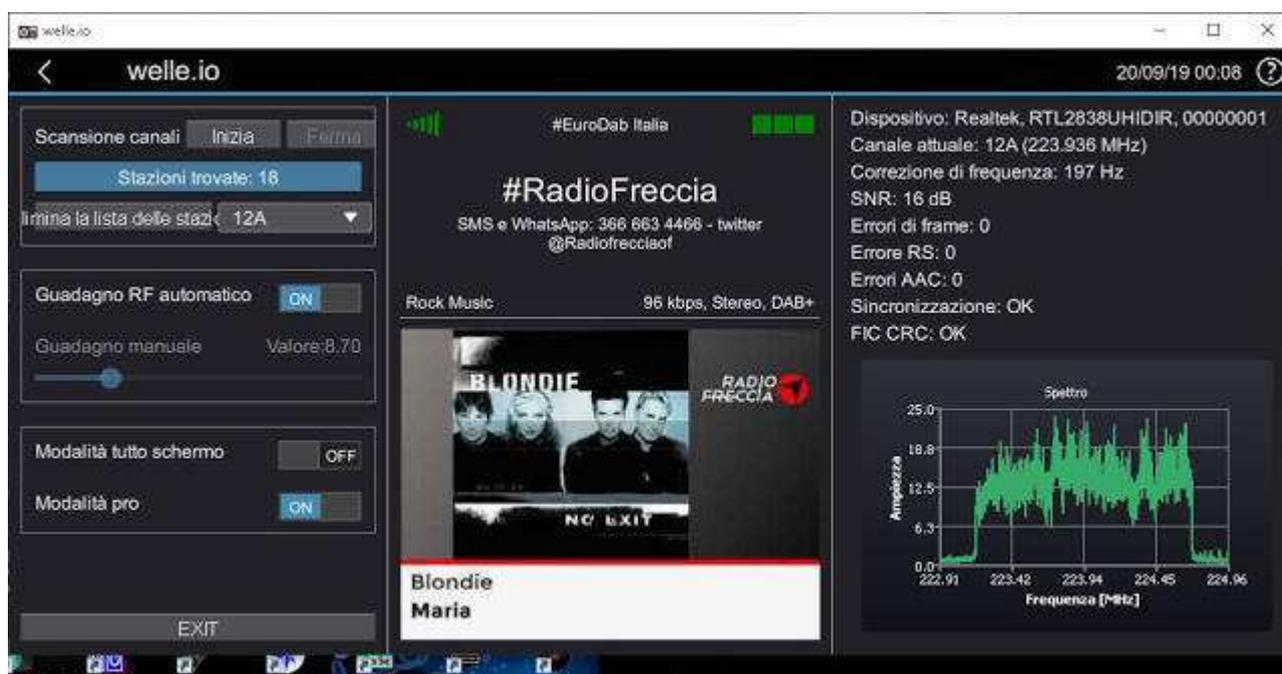
Sulla parte sinistra vi sono i tasti per effettuare la ricerca delle emittenti sui vari canali, nel mio caso l'unico canale è il 12A che corrisponde alla frequenza 223.936 MHz con 18 stazioni radio memorizzate. Offre la possibilità di regolare il guadagno RF ed impostare la modalità pro che abilita il lato destro della schermata.
