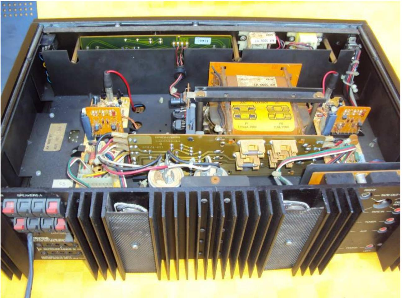
*particolare del dissipatore dei transistor finali*
