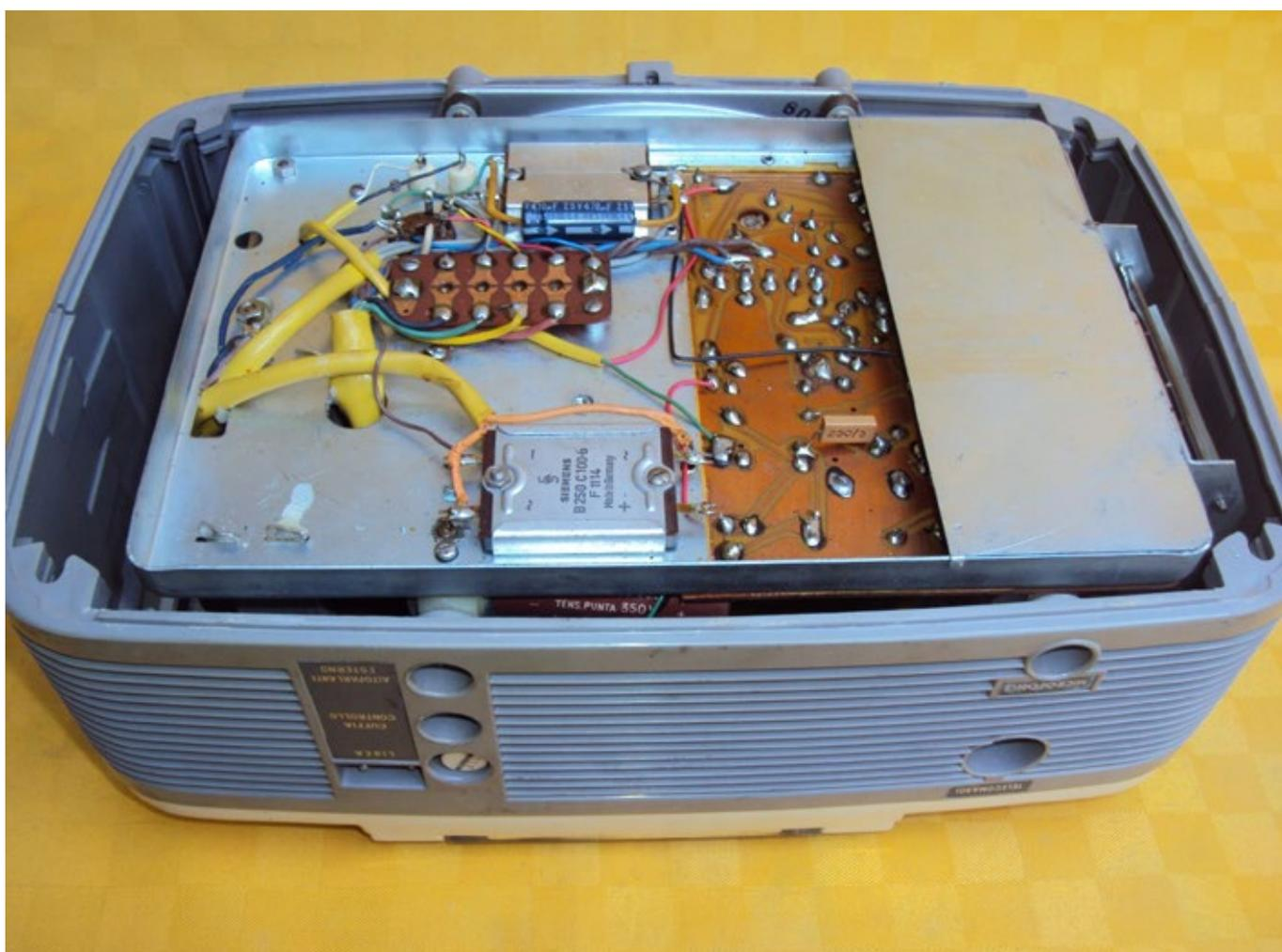
*G. 268 senza fondello per sostituzione condensatore*
