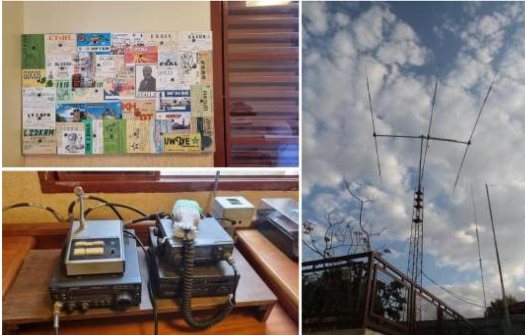
La stazione di Eni (PT2CA), semplice ma molto efficace, possiamo vedere un trasmettitore HF Kenwood TS-50S, accanto ad un trasmettitore VHF analogico, che mantiene il QAP sul ripetitore cittadino. Possiamo anche vedere una lavagna con più Qsl dei colleghi e delle attività speciali in esperanto. Infine la sua antenna Yagi a 3 elementi pronta per il suo prossimo DX
