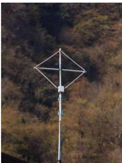
Figura 1: Il mio Loop autocostruito
