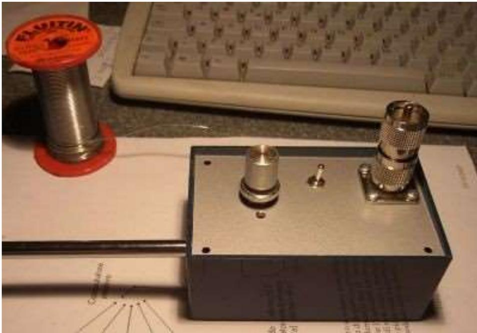
Date un'occhiata allo schema elettrico e di montaggio per meglio capire come sistemare le varie cose. Ecco la vostra antenne terminata pronta a funzionare, lavoro niente male, un connettore doppio maschio BNC permette di montare l'antenna direttamente dietro al FT-817, io ho preferito utilizzare un corto spezzone di cavo coassiale RG-58 per collegarla all'RTX.
