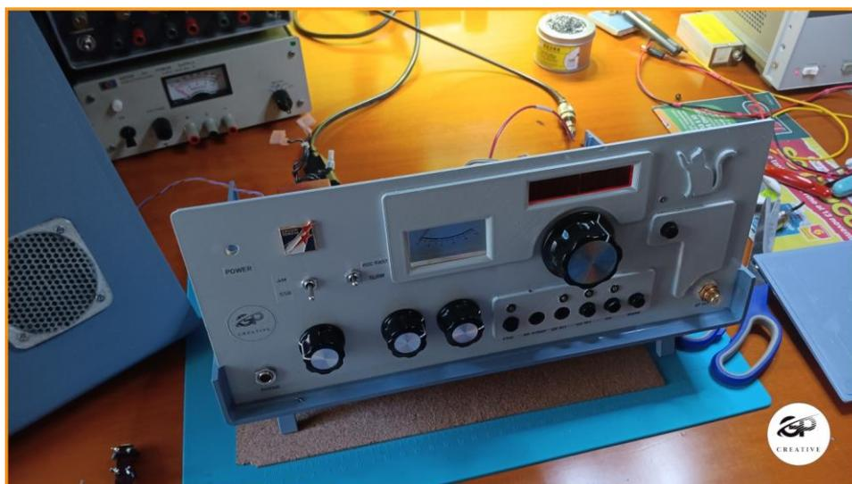
Questo progetto nasce dalla passione per l'autocostruzione e la sperimentazione nel mondo delle radiofrequenze. Si tratta di un ricevitore HF progettato specificamente per operare sulle bande dei 20 e 40 metri, e *broadcasting*, una scelta ideale sia per chi ama il mondo del radiantismo sia per chi desidera un dispositivo versatile e performante.
