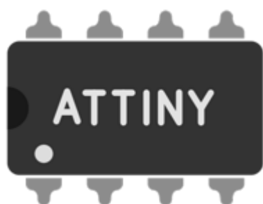
Figura 1: Attiny in contenitore DIP8;
