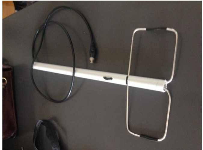
Figura 3: l'antenna ricevente UHF Moxon;
