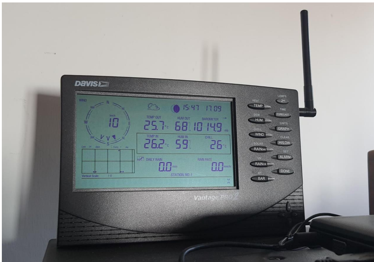
Figura 5: Consolle, interfacciata, via radio, con il modulo sensori;
