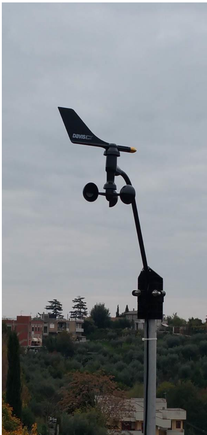
Figura 1: Anemometro e banderuola (velocità e direzione del vento);
