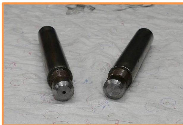
Le masse polari dopo l'operazione di tornitura
