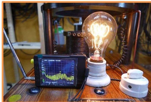
Il sistema inizia ad oscillare a 1.200 kHz, la lampadina I1 con funzione di carico fittizio si accende vigorosamente
