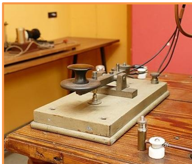
Tasto telegrafico del tipo molto pesante
