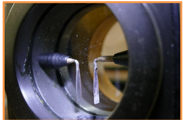
Lamelle B e C in acciaio inox TP 316
