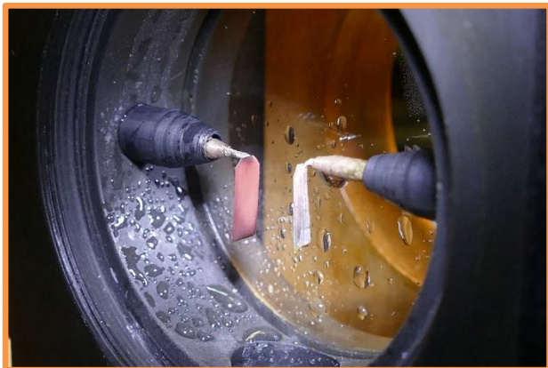
Lamelle B e C (si pensava di platino) collegate alla sorgente di corrente continua
