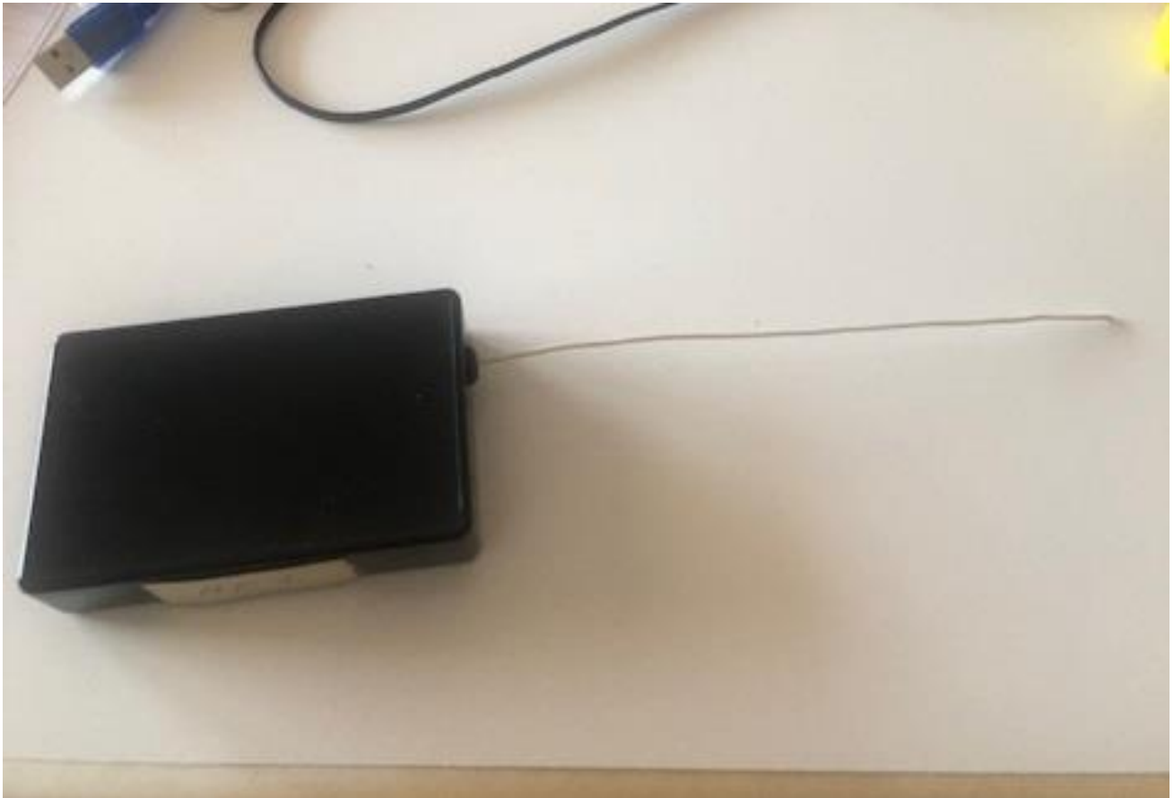
Figura 1: Il beacon per radiocaccia ARDF, con antenna in quarto d'onda, nel suo contenitore da 100X60X25mm;
