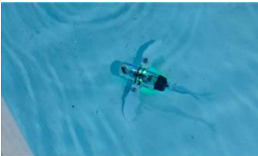
Figura 4: Il “Sea Glide” si trova a fondo della piscina. Il LED verde indica l’inizio della procedura di svuotamento della siringa;
