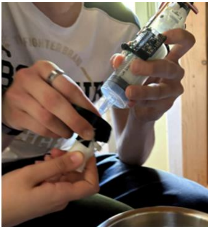
Figura 3: La delicata fase di inserimento della punta della siringa all'interno del tappo della borraccia, evitare infiltrazioni d'acqua che possano danneggiare l'elettronica;
