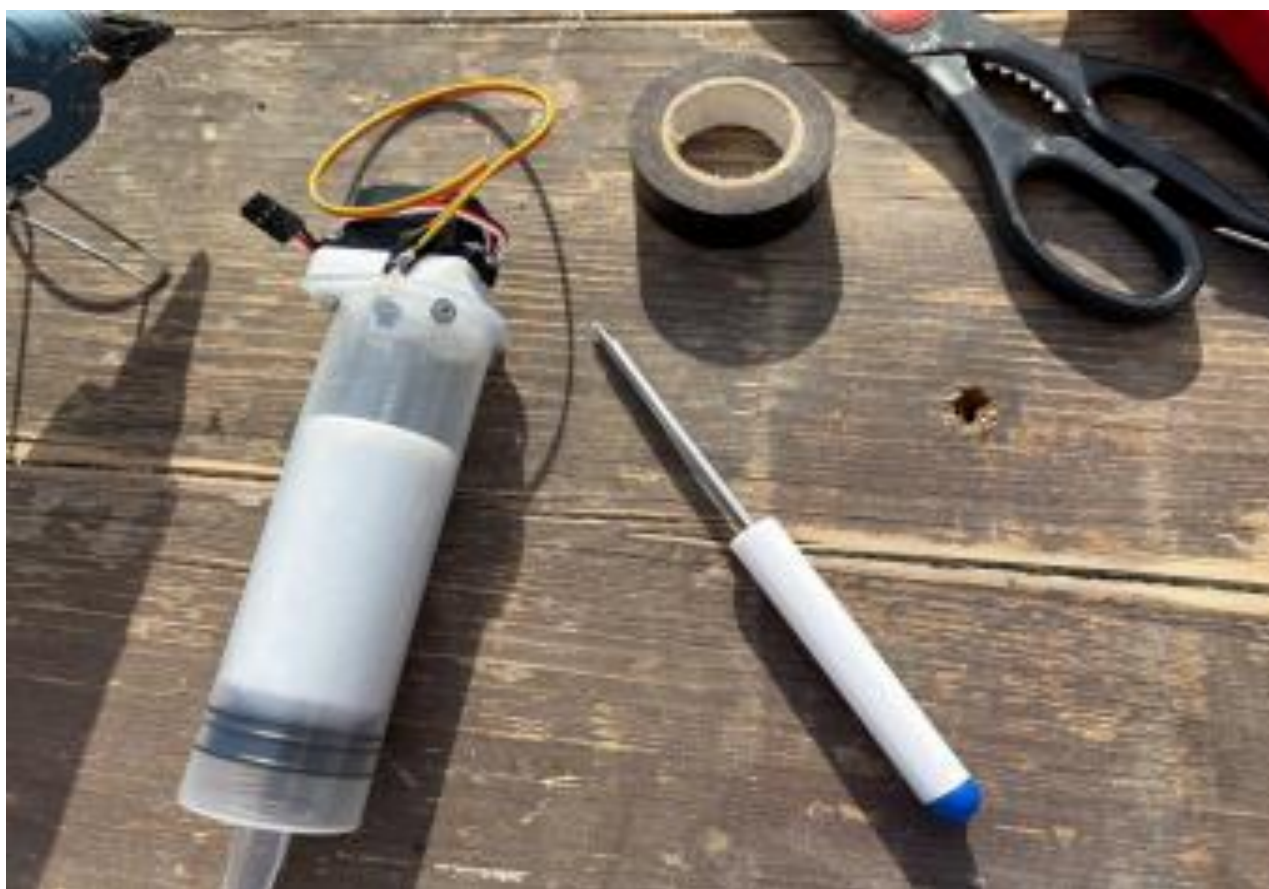
Figura 1: La siringa modificata per permettere l'entrata e la fuoriuscita di acqua. In cima è situato il servomotore che gestisce lo stantuffo tramite un bullone, fissato con un componente stampato in 3D. Inoltre è presente un piccolo pulsante per indicare al "Sea Glide" il "fine corsa" nella fase di riempimento;
