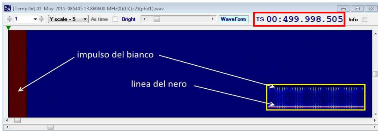
Figura 9.2 – struttura del frame di 500 msec relativo al phasing signal
