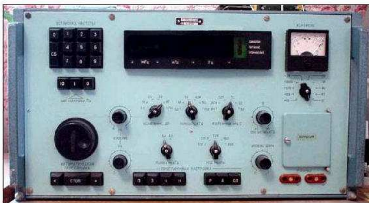
Стационарный супергетеродинный коротковолновый радиоприемник КАТРАН
