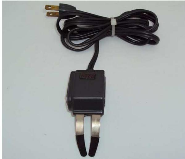
**SI TRATTA DI UNO SMAGNETIZZATORE PER TESTINE MAGNETICHE PER REGISTRATORI A NASTRO** .Oggetto abbastanza comune tra gli audiofili e appassionati di registratori a nastro tipo AMPEX-REVOX- AKAI- GRUNDIG – GELOSO LESA ecccc....
