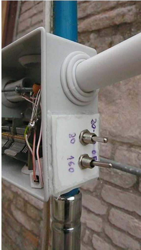
Io ho scelto di usare alcuni pezzi di plastica, recuperati dal coperchio di una vaschetta di gelato, per realizzare delle mascherine forate, su cui ho fissato il variabile e gli interruttori a levetta. Le mascherine sono poi state fissate alla scatola con la colla a caldo, solo dopo aver verificato accuratamente che i collegamenti siano stati effettuati correttamente e che l'antenna funzioni su tutte le bande.
