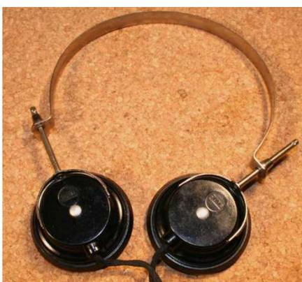
**NDR** : "il circuito funziona meglio impiegando una cuffia ad alta impedenza da 2000 ohms o più".
