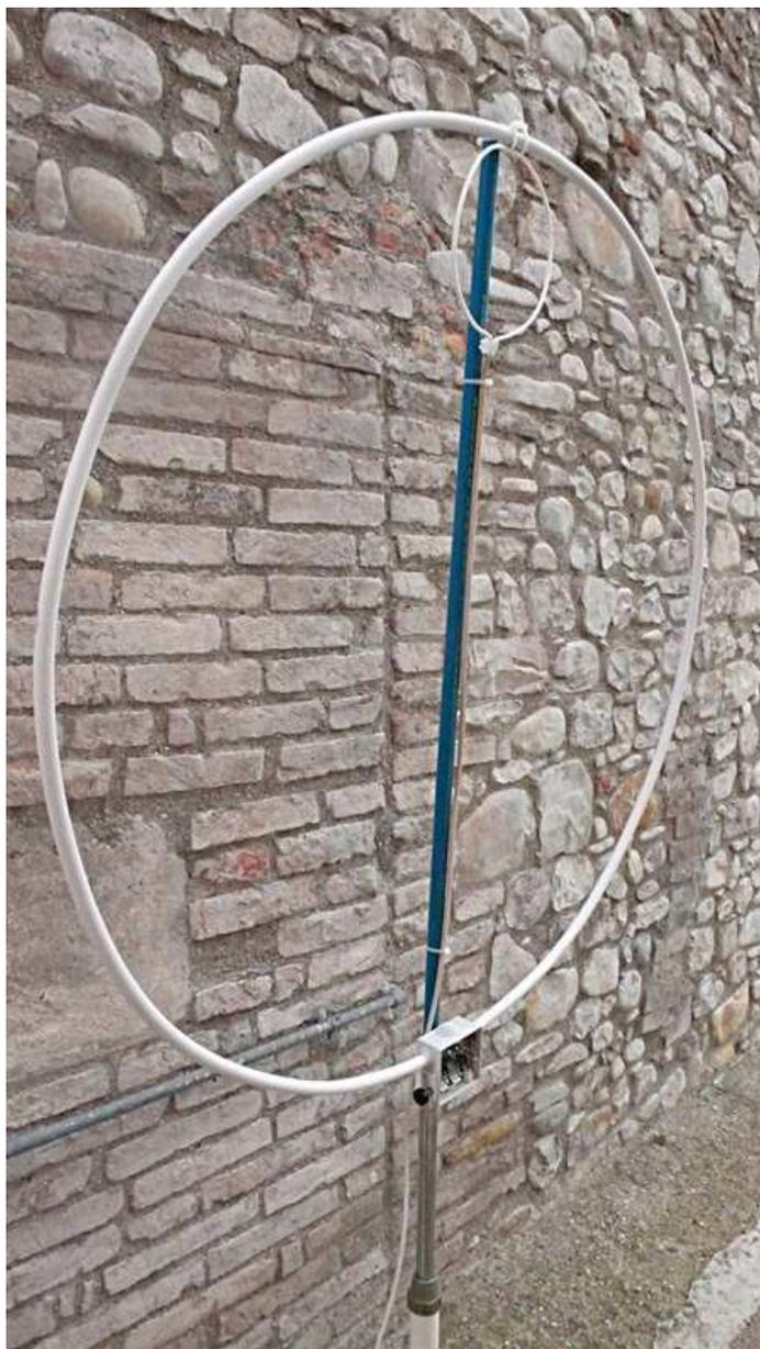
E' importante prima di fissare i componenti nella scatola, predisporre i fori per il fissaggio della stessa sul piedistallo, poiché una volta fissati i componenti, non è più possibile forarla. Io ho fatto due semplici fori e ho fissato la scatola al montante con una semplice fascetta di plastica.
