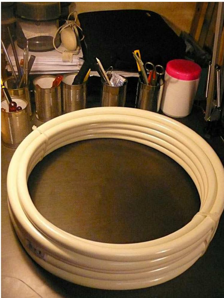
Questo è il tubo in alluminio molto leggero e robusto, lo potete trovare nei negozi di materiale idraulico o al Leroy Merlin. Viene venduto arrotolato in matasse da 3-5 o 10 metri, ha uno spessore de 16 o da 20 mm.
