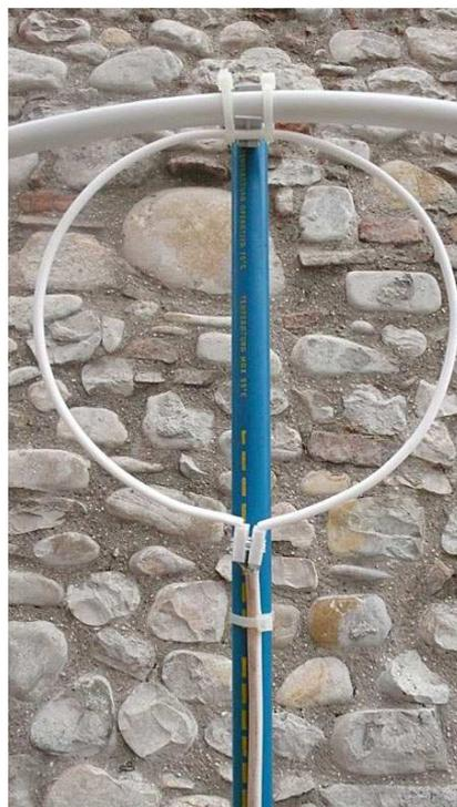
Fissiamo con un mammut il controlloop ad un paio di metri di cavo TV, per collegare l'antenna al ricevitore. Infine fissiamo sull'estremità del cavo TV le boccole o la presa BNC.
