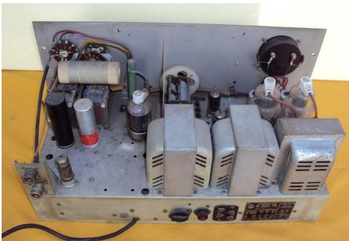
**Telaio G 222 Tr seconda serie sono presenti solo tre trasformatori**
