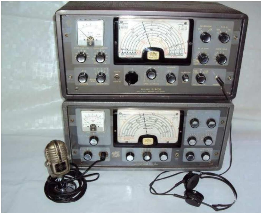
**Stazione completa con G 222 Tr seconda serie con ricevitore G4/ 214 seconda serie con cuffia e microfono N° 1100**
