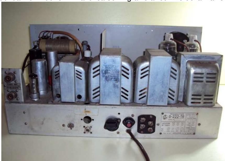
**Telaio G 222 TR prima serie in evidenza i quattro trasformatori**
