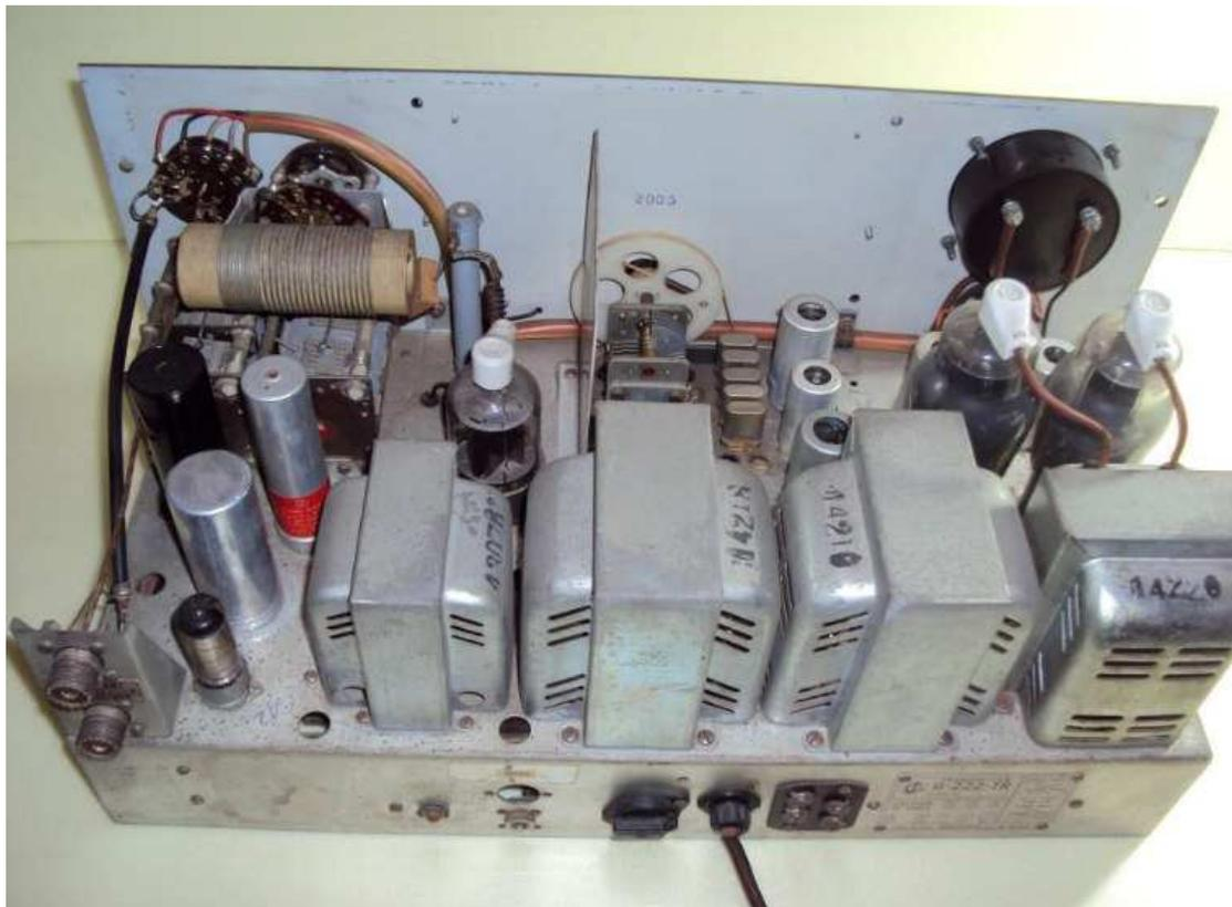
Telaio G 222 Tr Prima serie visto dall'alto a sinistra il P-greco e la 6146 a destra le due 807 del modulatore
