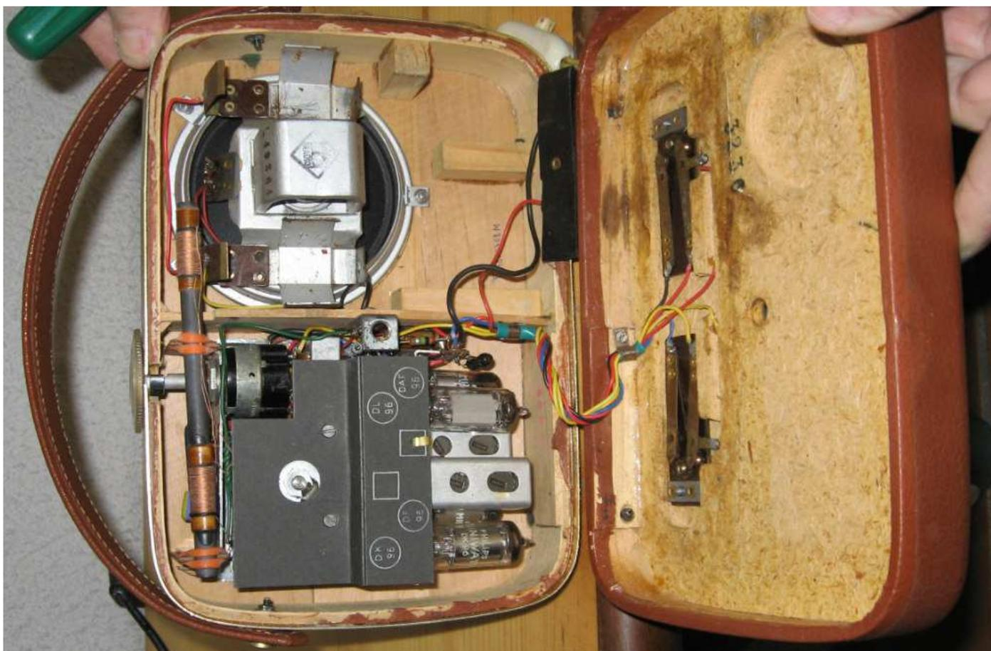
Questo piccolo color nocciola con dietro applicato l'adattatore di rete 220V si chiama "**CAMPING 2**" e riceve solo le onde medio lunghe (Valvole miniatura) alimentazione a rete con adattatore esterno color avorio e a batterie.
