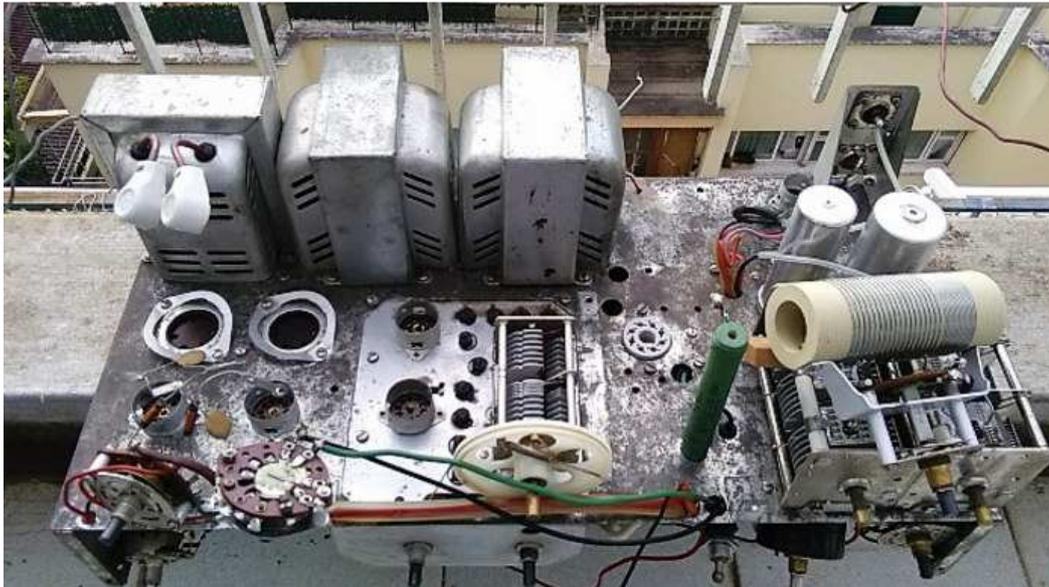
anche se i particolari in ceramica puliti fanno tutt'altro effetto.....L'acqua non rovina nulla, basta evitare di bagnare trasformatori, impedenze, medie frequenze etc....e una radio sanitizzata si maneggia con più soddisfazione.....
