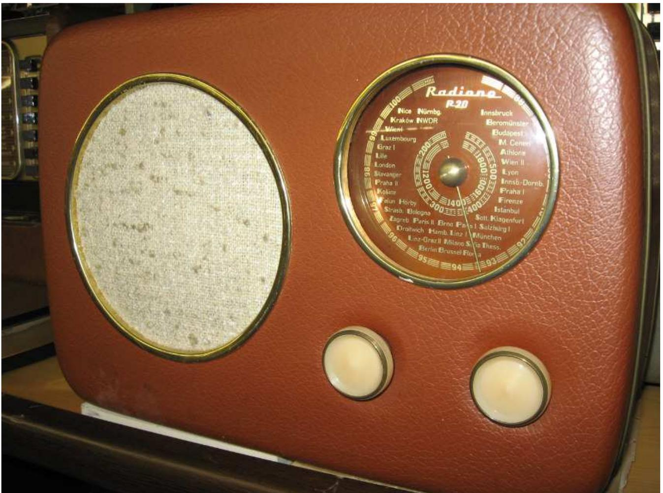
**RADIONE R20** Color nocciola ha i tasti color avorio nella parte superiore e l'antenna a nastro è dotato anche di FM ( Valvole miniatura alimentazione rete e batterie )
