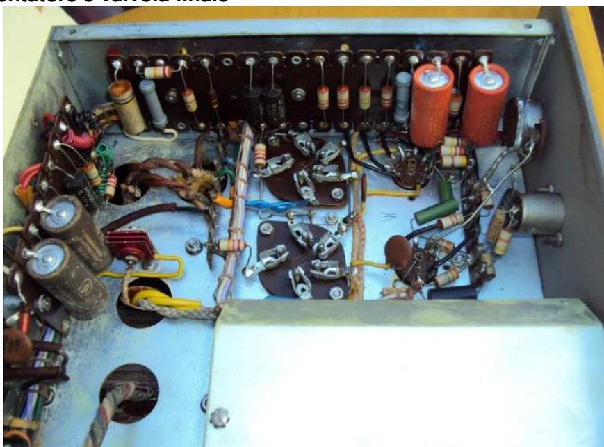
**Sezione modulatore si intravedono gli zoccoli delle 807**
