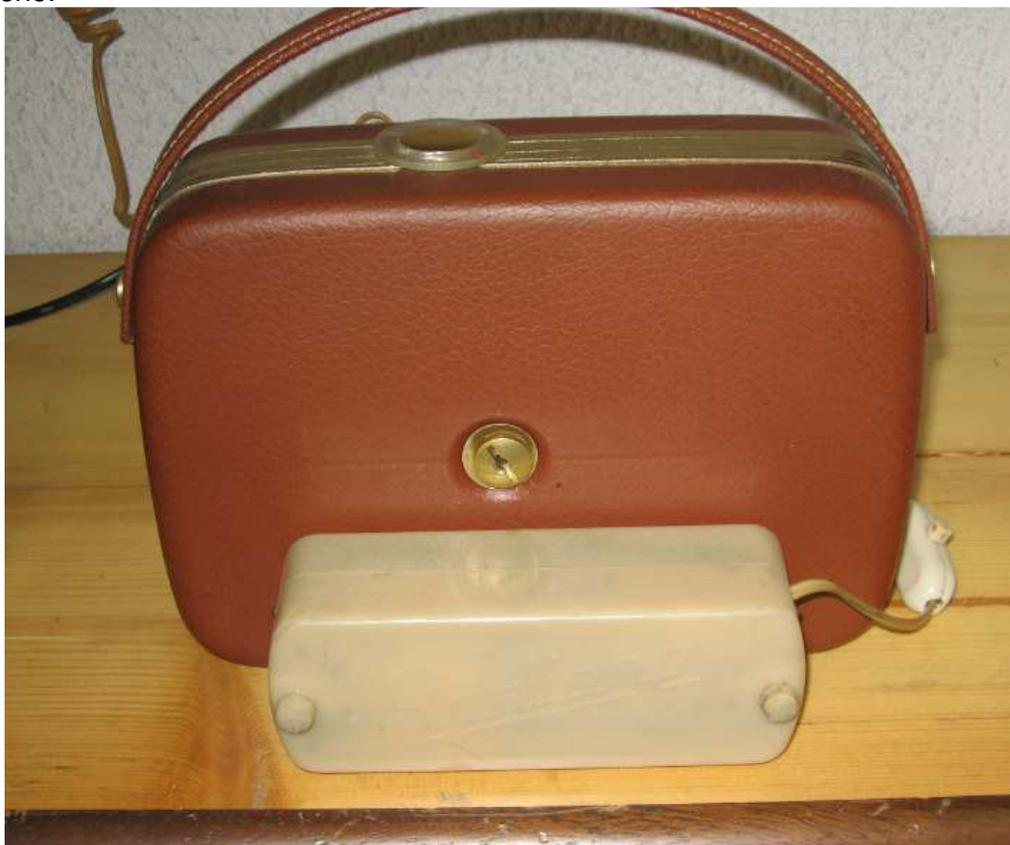
Notare l'alimentatore abbastanza voluminoso in paragone alla radio, produzione anno 1956, valvole impiegate : DK96 / DF 96 / DAF 96 /DL 96.
