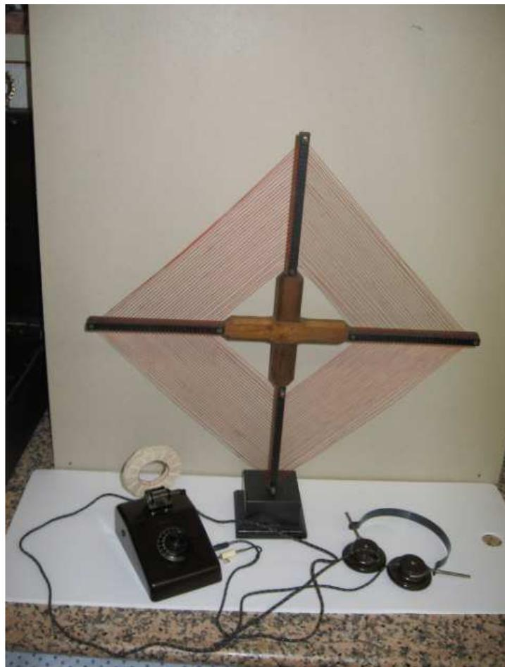
Foto di antenna a quadro in abbinamento a radio a galena marca RUMA e relative cuffie ad alta impedenza
