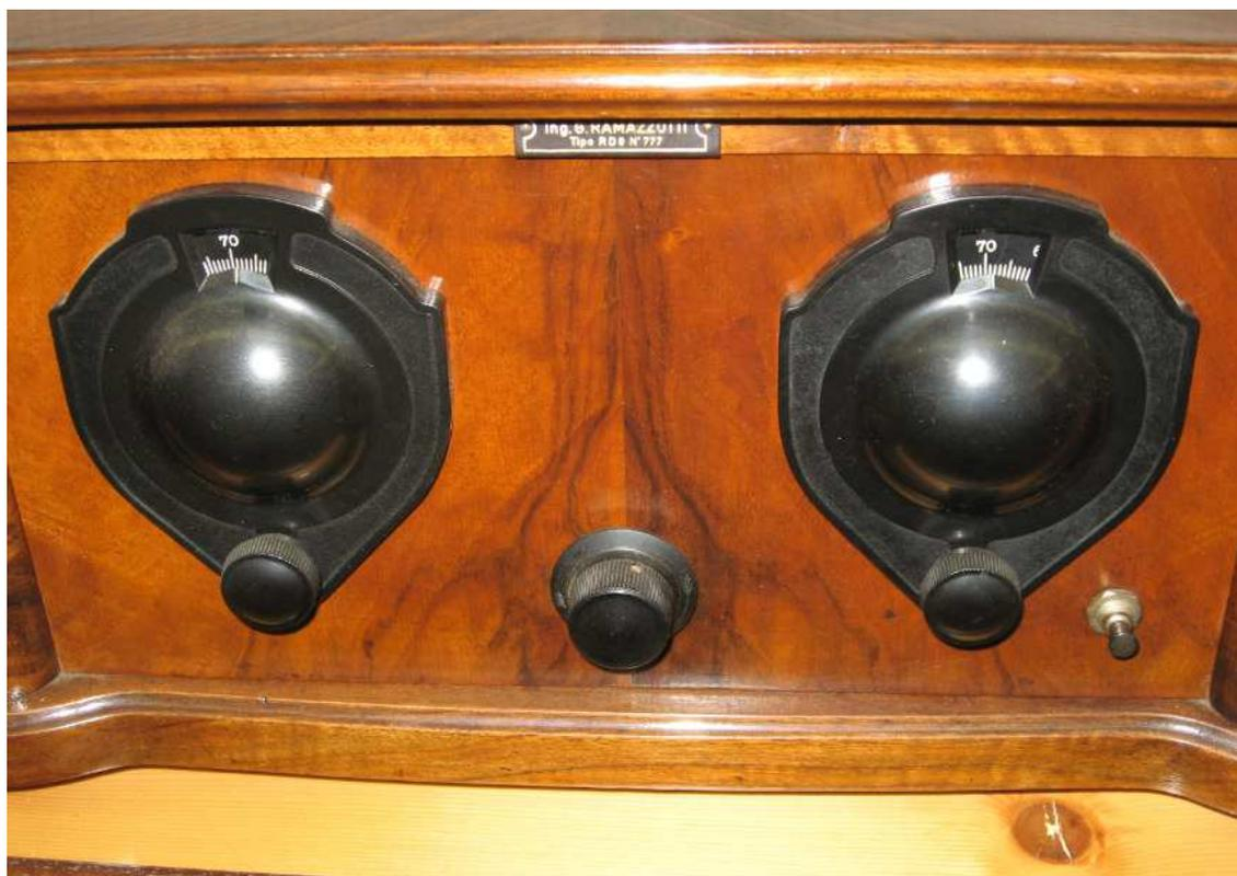
**Primo piano dei vernieri di sintonia precisi e di grandi dimensioni realizzati in pesante bakelite.**
