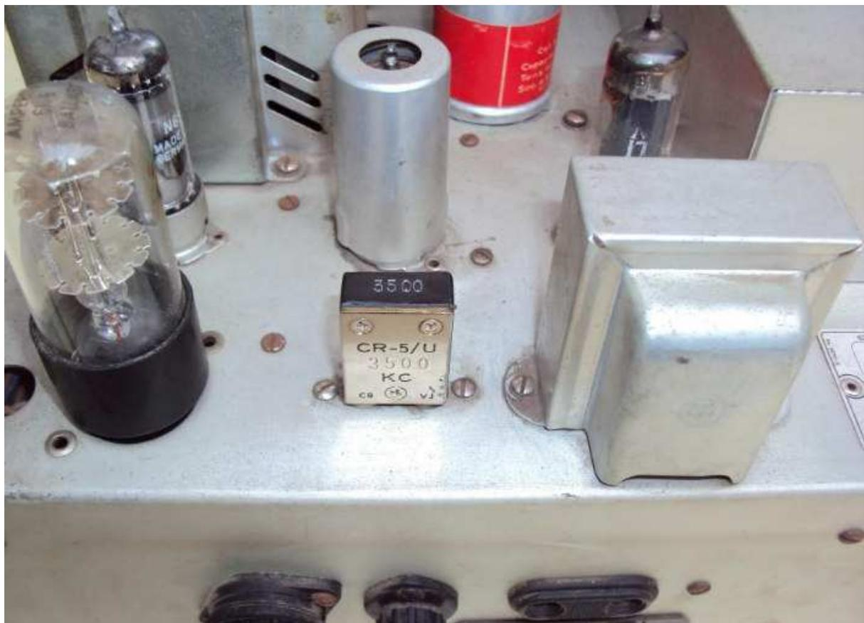
**Quarzo del calibratore speciale del G 209 Siemens Hell**
