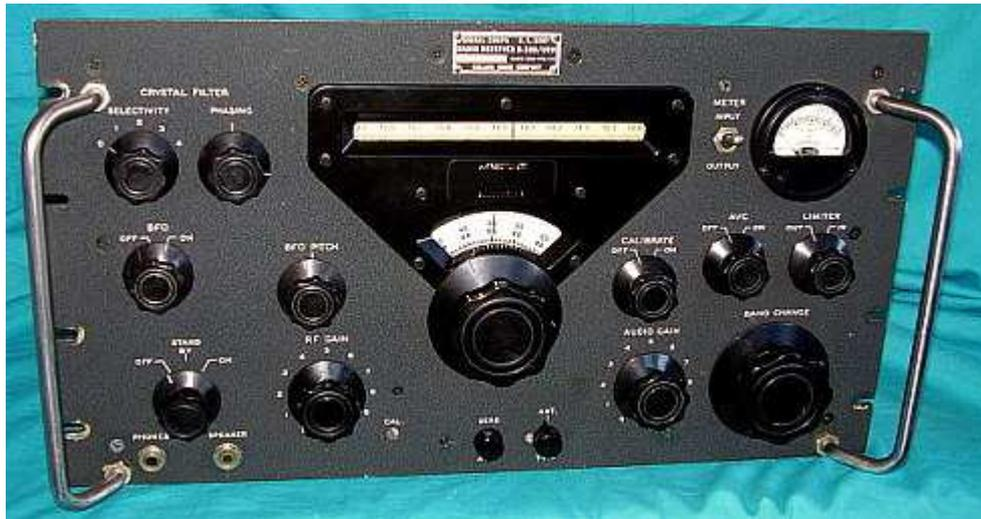
Il ricevitore R388/URR è la versione militare del **Collins 51 j 1/2/3/4**, supereterodina a 18 tubi, AM-CW da 0,5 a 30,5MHz. La gamma di sintonia è divisa in 30 bande di 1 MHz, la manopola di sintonia fa ruotare la scala circolare graduata in kHz e compie 10 rotazioni per ogni settore di 1 MHz. Montaggio a rack .
