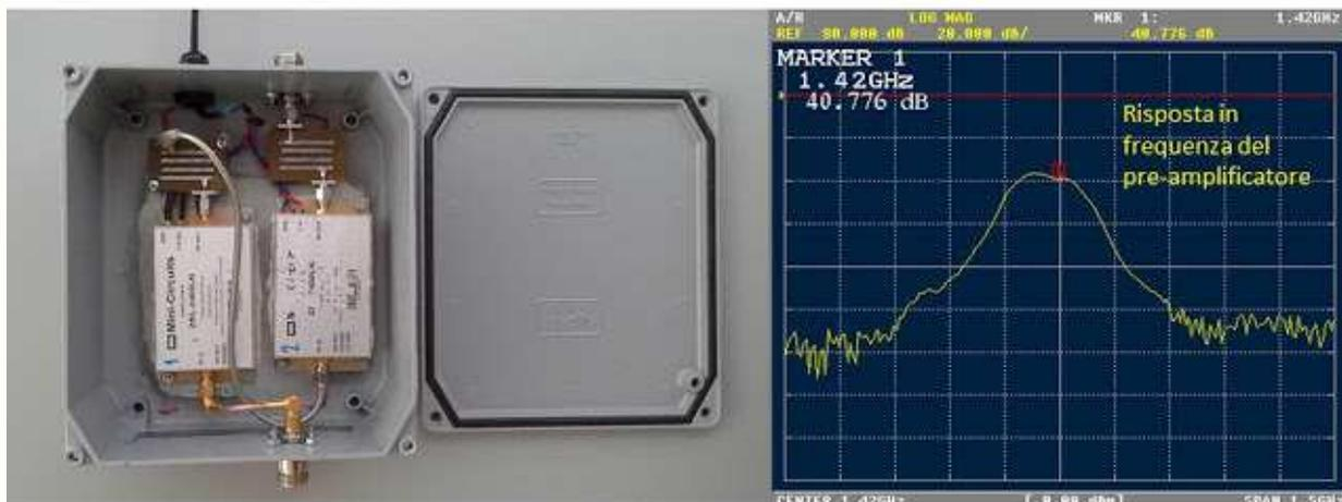
L'amplificatore è realizzato con 2 dispositivi ZRL-2400LN in cascata: all'uscita di ogni amplificatore è inserito un filtro passa-banda (BW=200 MHz).
