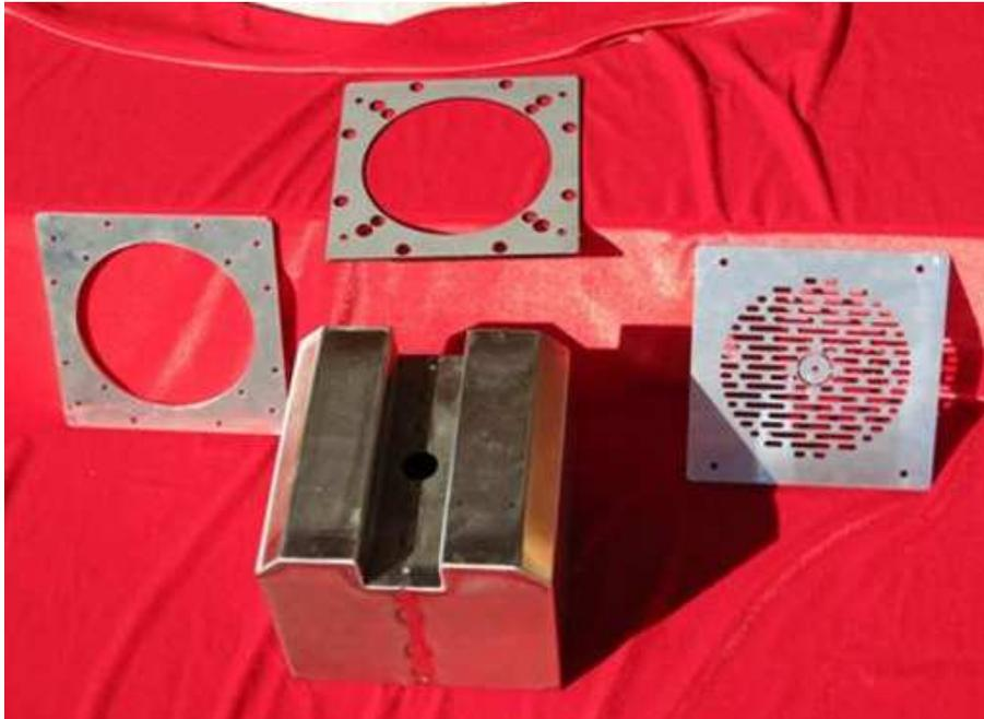
Prototipo di RS RadioSpeaker **Mk3**, costruito in Acciaio 18/10, ancora da verniciare.
