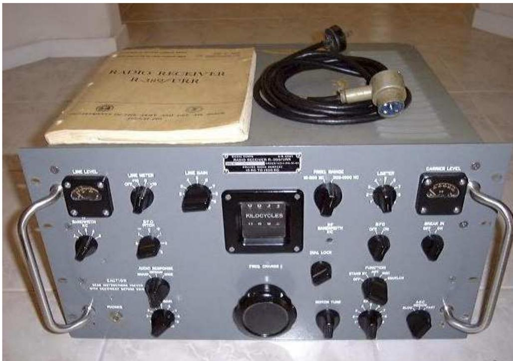
Ricevitore per impiego generale uso fisso. AM-CW-RTTY da 15 a 1500 KHz, supereterodina a doppia conversione, la gamma bassa ha 5 bande da 500 a 1500 KHz, mentre quella alta da 500 a 1500 KHz ne usa 2. Esso fa parte con i tipi R-390 ed R-391 di una serie unitaria con accessori intercambiabili.
