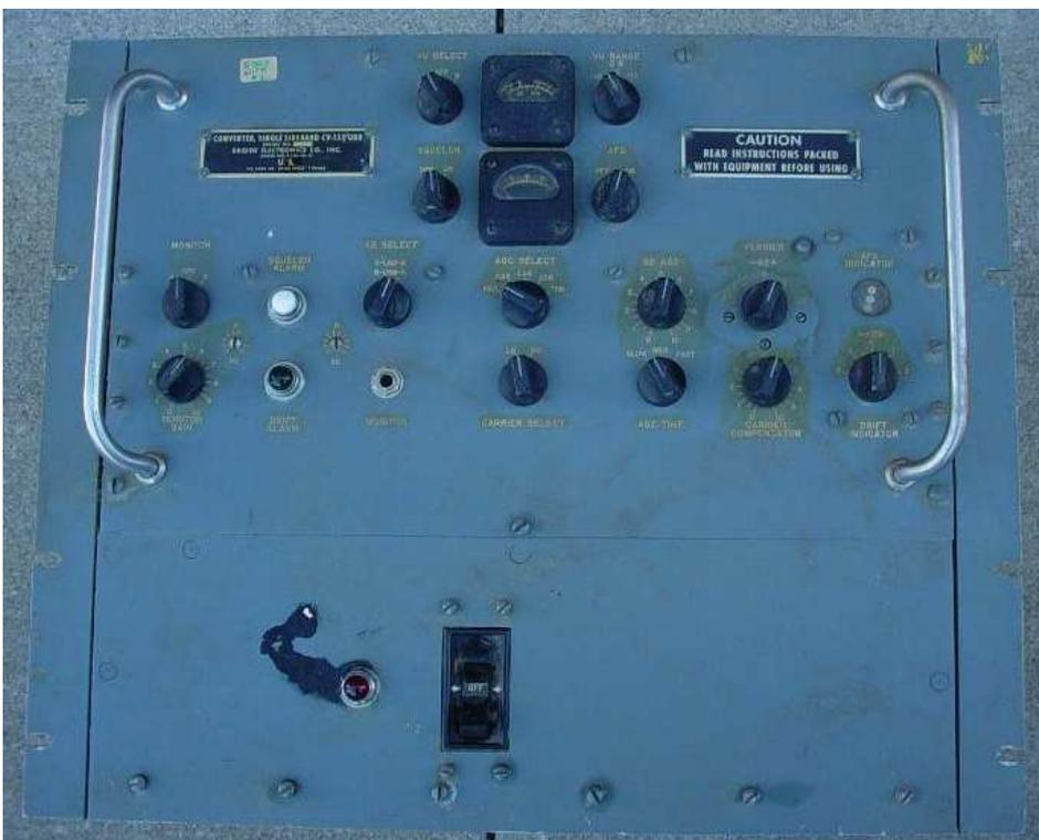
Converter per banda laterale destinato ad essere collegato all'uscita IF di ricevitori per telecomunicazioni.
