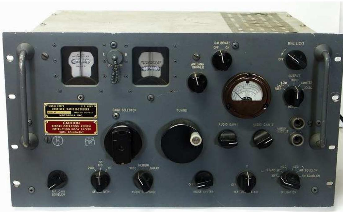
Ricevitore supereterodina a tripla conversione AM-CW-CW modulato ed FM sulla gamma di frequenze fra 20 e 237 MHz. (Prodotto intorno alla metà degli anni Cinquanta da Motorola su disegno Collins)
