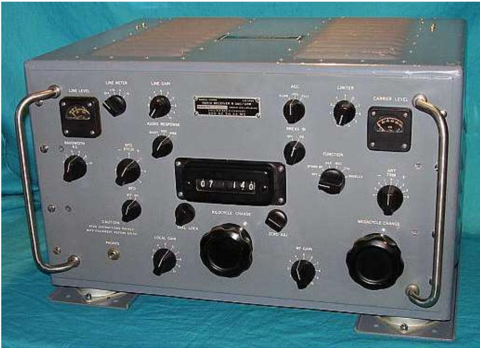
Ricevitore di elevate prestazioni e stabilità, AM-CW-RTTY da 0,5 kHz a 32 MHz, supereterodina a 33 valvole. Realizzato in contenitore per rack. La sintonia viene effettuata mediante due manopole rispettivamente MHz e KHz, la calibrazione del ricevitore permette una precisione di sintonia (a permeabilità variabile) pari a 3/10KHz)
