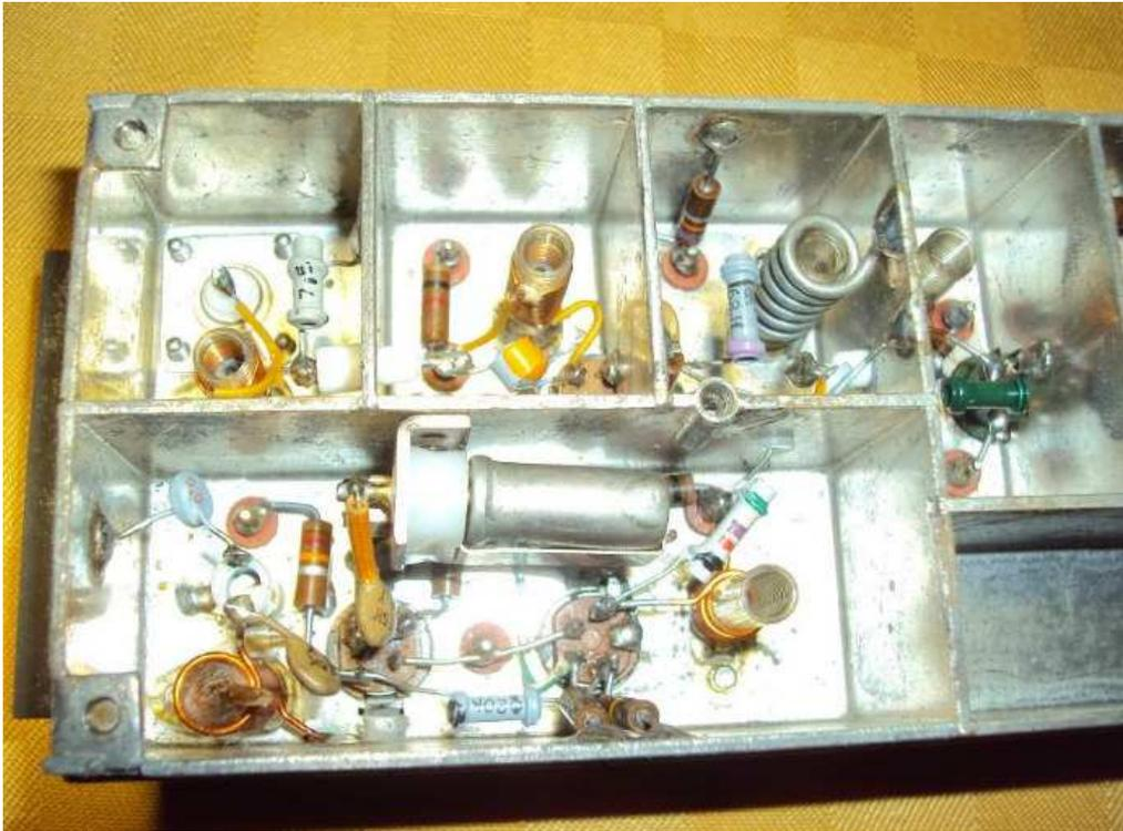
**Convertitore a Nuvistor G4/161 internamente in primo piano il quarzo dell'oscillatore**
