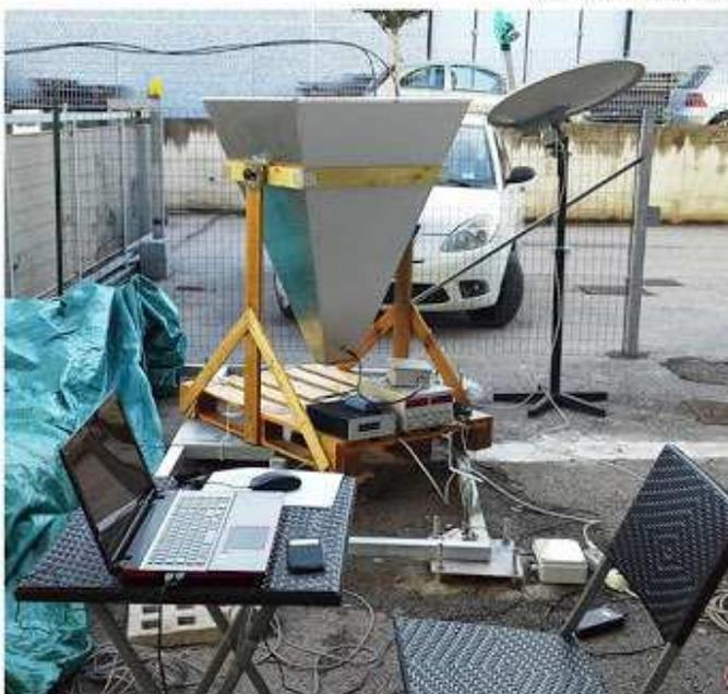
**Impianto ricevente sperimentale per la ricezione della riga a 21 cm dell'idrogeno.**
