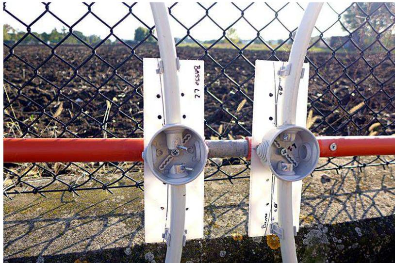
Una volta assemblate le due antenne, le ho impermeabilizzate con 2 mani di Plastidip Spray.
