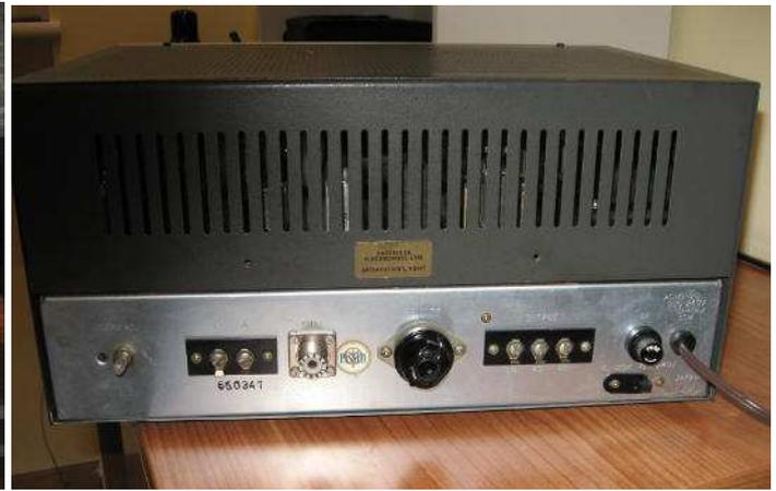
Nella semplicità dell'insieme c'è da notare che la Trio specifica nel Manuale d'uso l'adozione in media frequenza di filtri meccanici risonanti a 455 KHz ( non certo per qualità come quelli della Collins ) filtri che assicurano circa 5 KHz di selettività, sufficiente per l'uso in AM ed un po' larghi per ascolto di SSB/CW.
