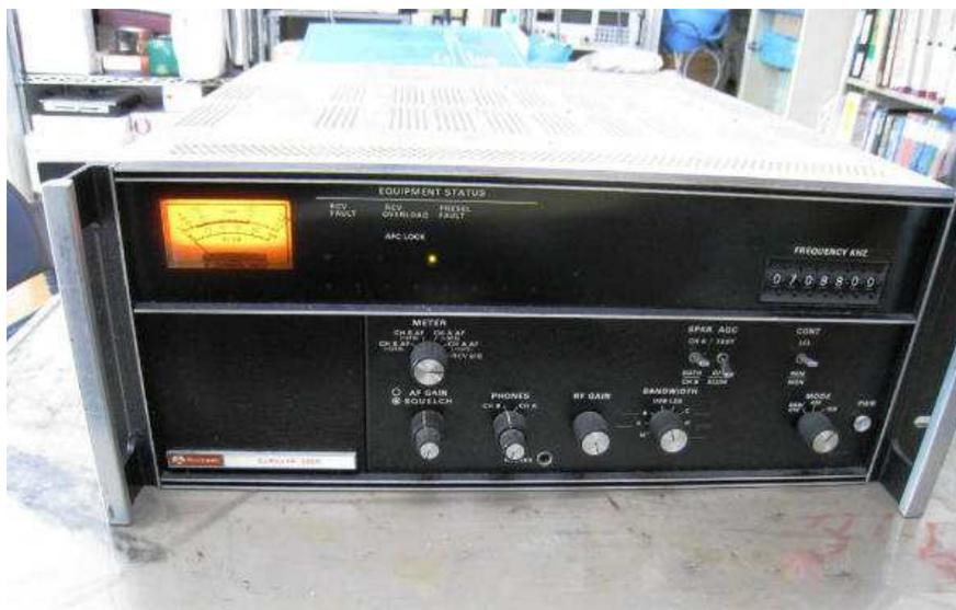
**Ricevitore HF 8050** riceve da 250 KHz a 30MHz in ISB, LSB, USB, CW e AM
