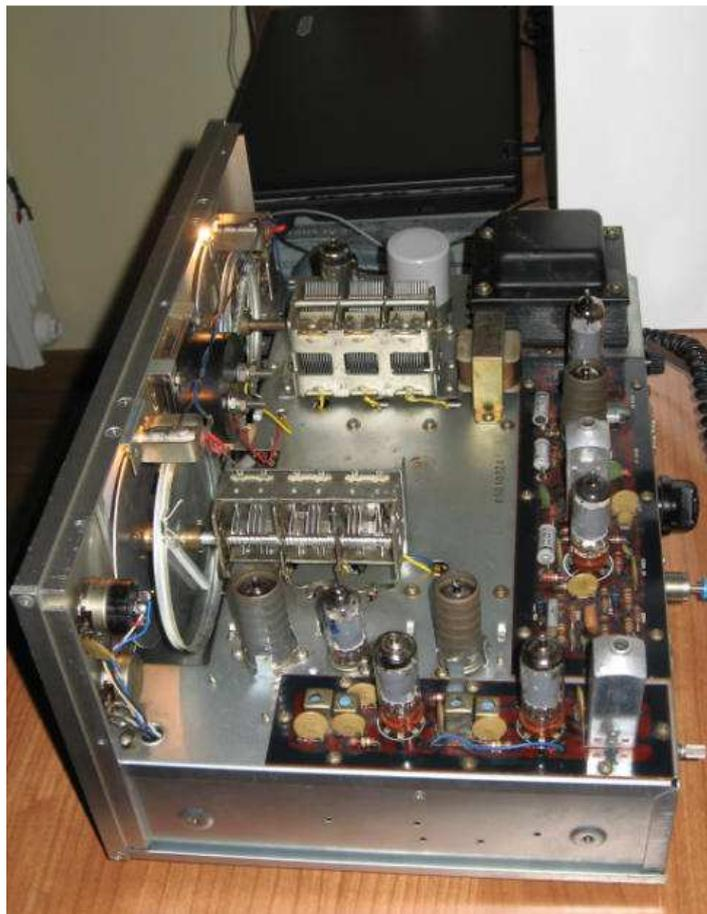
Pannello per accedere ai vari nuclei e compensatori per la taratura delle 4 gamme da 0,55 a 30 MHz
