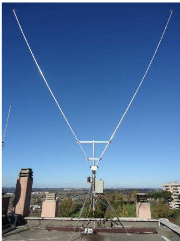
**Figura 1** Antenna Delta loop con accessori
