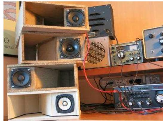
Ho Costruito 8 prototipi di cassa con tromba ripiegata utilizzando altoparlanti, dimensioni, e coefficienti di espansione diversi. **I risultati e le conclusioni le lasciamo alla prossima puntata.**
