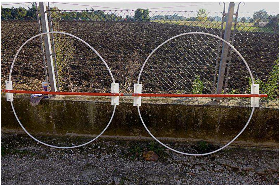
2 staffe per ogni loop, ritagliate da un foglio di polietilene da 5mm, sono servite per fissare i loop alla struttura.
