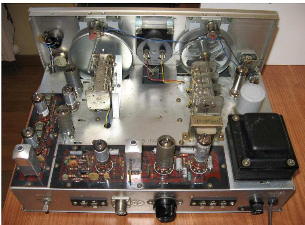
*Apparecchio radio aperto con in mostra tutti i vari componenti : valvole della serie miniatura ,trasformatori di alimentazione e di media frequenza e BFO, i due condensatori variabili ad aria per la sintonia normale e per la sintonia a bande allargate sulle gamme radioamatoriali di 80,40,20,15 e 10 metri.*
