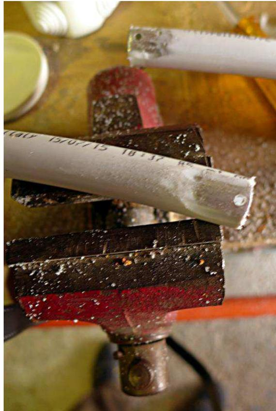
Prendiamo ora le scatole stagne, tagliamo i gommini per far passare le due estremità del tubo di ogni Loop, in modo che il tubo vi entri forzando i gommini, infiliamo le estremità dei loop nelle scatole stagne, e infine infiliamo nei buchi delle estremità del tubo, delle piccole viti metalliche con dado e controdado, che costituiranno i morsetti dei contatti elettrici di ogni loop.
