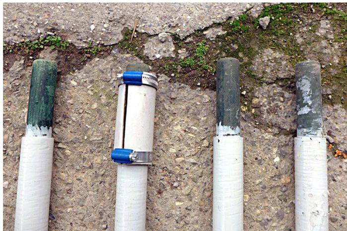
Questa soluzione, permette in maniera economica, di costruire pali d'antenna flessibili, ma sufficientemente robusti, da resistere anche a venti molto forti. I pali di sostegno delle mie antenne Flag, sono costruiti in questo modo, e resistono senza bisogno di manutenzione da oltre 3 anni, a vento, gelo, sole e intemperie.
