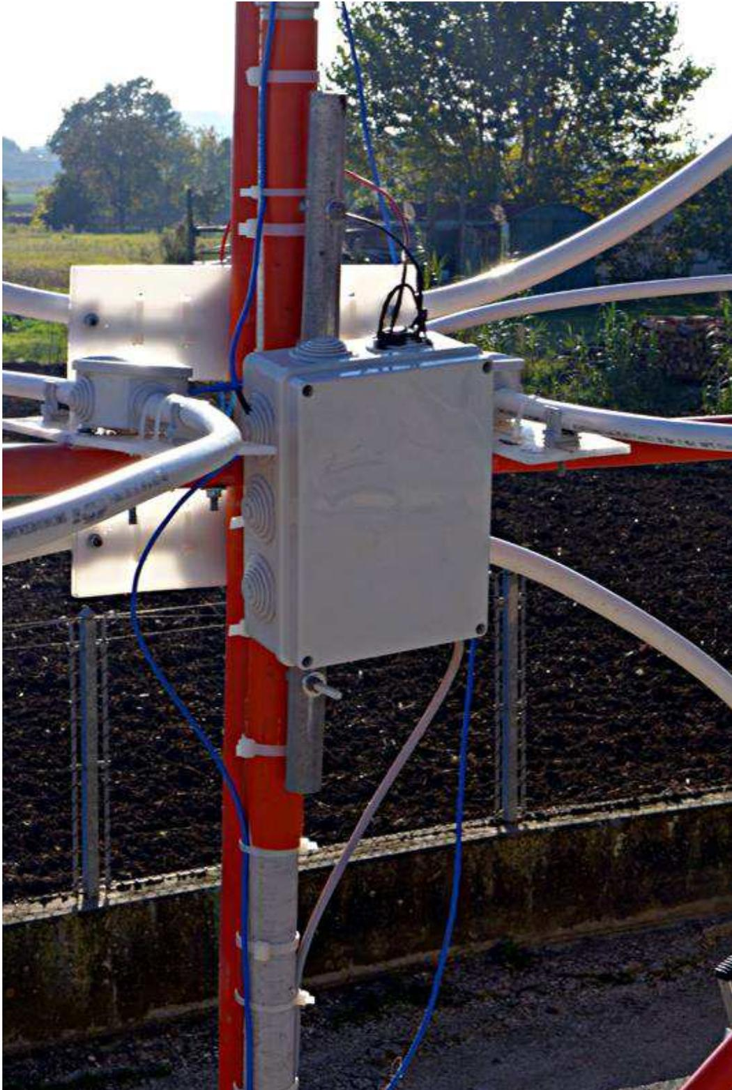
Per garantire un maggior grado di protezione dall'umidità e dalle intemperie, la piccola scatola stagna fornita in dotazione con il Kit di LZ1AQ, è stata chiusa in una scatola stagna più grande. Ho effettuato tutti i collegamenti dei Loop e del Dipolo, come da istruzioni in dotazione, che tra l'altro sono chiare, dettagliate, e si trovano sul sito di LZ1AQ anche in italiano. Infine, ho
