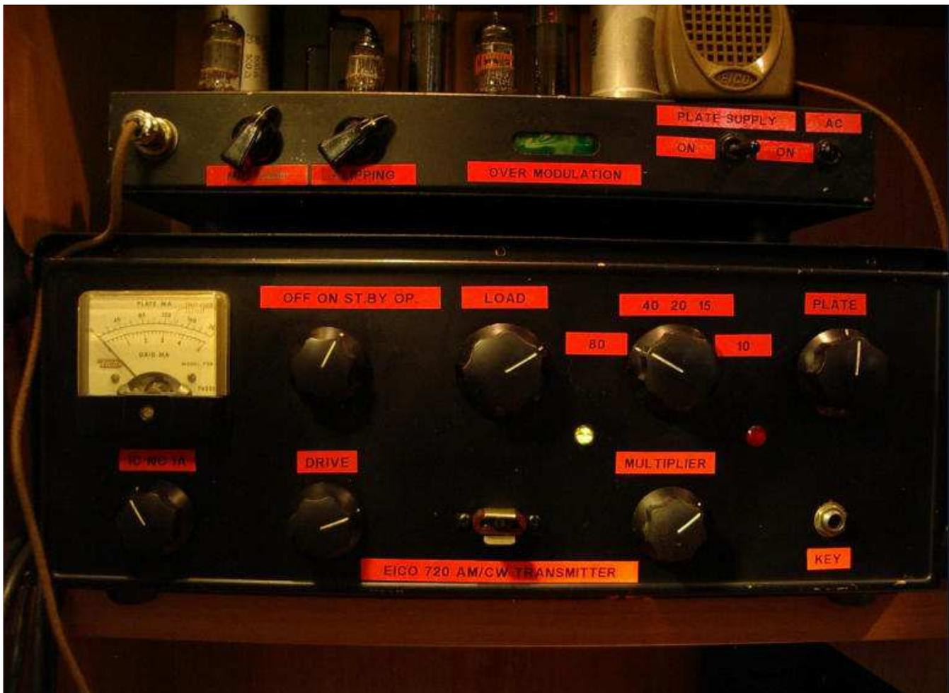
**EICO 720 + 730 come era all'origine** non vi dico a sverniciarlo...il modulatore è stato smontato pezzo per pezzo ed il telaio è stato fatto ramare, poi rimontato da capo.
