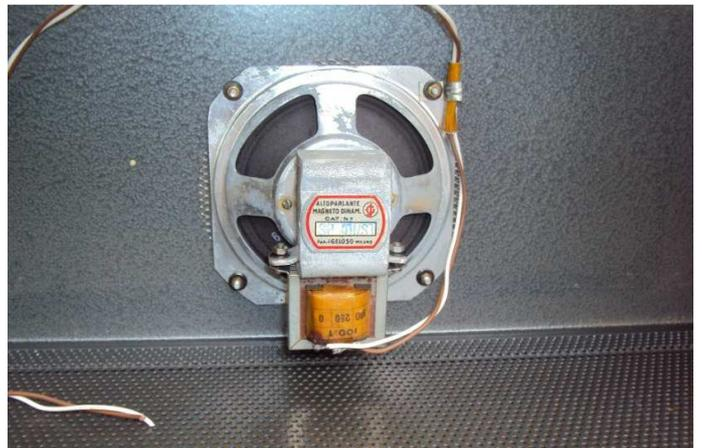
Altoparlante spia dotato di trasformatore di linea
