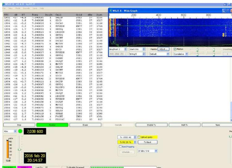
Si tratta di un protocollo per comunicazioni digitali che permette di trasmettere e ricevere segnali estremamente deboli. Lo scopo principale per cui è stato sviluppato il **WSPR** è quello dello studio della propagazione radio ionosferica. La modalità di funzionamento avviene secondo la filosofia dei beacon. Utilizzando la modalità **WSPR** si è in grado di ricevere segnali di intensità ben inferiore a quelli di un segnale in **CW** e anche di quelli nelle varie modalità **JT**.
