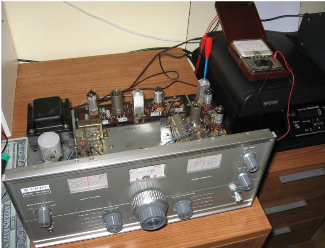
**Foto del telaio del Trio ove si vede la fase della taratura" casalinga", si noti il cacciavite antinduttivo col manico rosso posizionato nel nucleo superiore del trasformatore di media frequenza ed il tester ICE 680 per misurare l'uscita in BF.**
