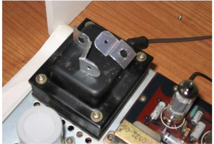
**Lavorazione delle due placchette in alluminio adeguatamente sagomate allo scopo di ferma valvole.**
