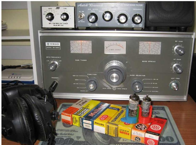
Il ricevitore Trio finalmente completato ( con diverse valvole di ricambio ) e dell'insieme della mia attuale " Stazione di Ascolto ": RX Trio 9R-59DS, Antenna Tuner MFJ-956 e QF -1A Active Audio Filter , antenna Long Wire tesa a 10 metri di altezza
