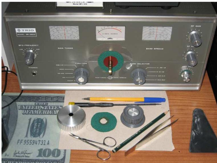
**Posizionamento e messa in opera dei 2 dischi in acetato ( trasparente e rosso ) e del disco di frizione atto a sanare il gioco del perno della sintonia, disco realizzato in panno di feltro colore verde**
