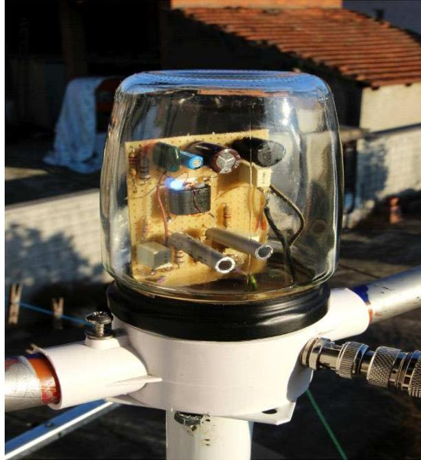
Le prime impressioni sono estremamente positive, nessun segno di intermodulazione e ottima ricezione fin da **20 kHz a 30 MHz**. Certo, è sempre meglio usare un preselettore o almeno dei filtri per le onde medie, in quanto Rai1 da Volpiano, a me vicinissima sui 999 KHz riesce sempre a saturare gli ingressi dei ricevitori, ma succede anche con l'ala 1530. In alternativa un attenuatore riduce il rischio che ciò accada.
