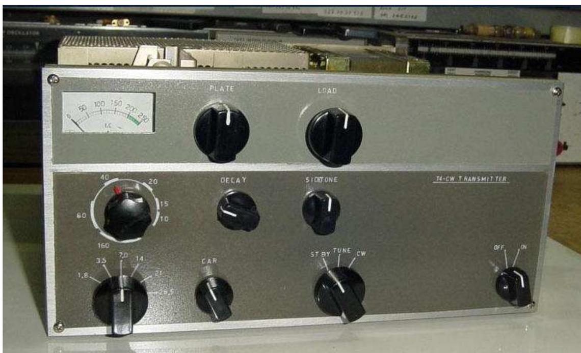
Un collega radioamatore mi ha chiesto se era realizzabile un **TX CW QRP**, questa è l'occasione di mettere finalmente in opera quel telaio rottame di un T4-XC Drake. Si è scelto il funzionamento reciter, cioè il TX funziona abbinato ad un qualunque ricevitore Drake della serie R4, il segnale per la sintonia viene prelevato dalla presa INJ. Lo stadio finale monta una coppia di tubi **2E26**, per una potenza **OUT di 15 W**.
