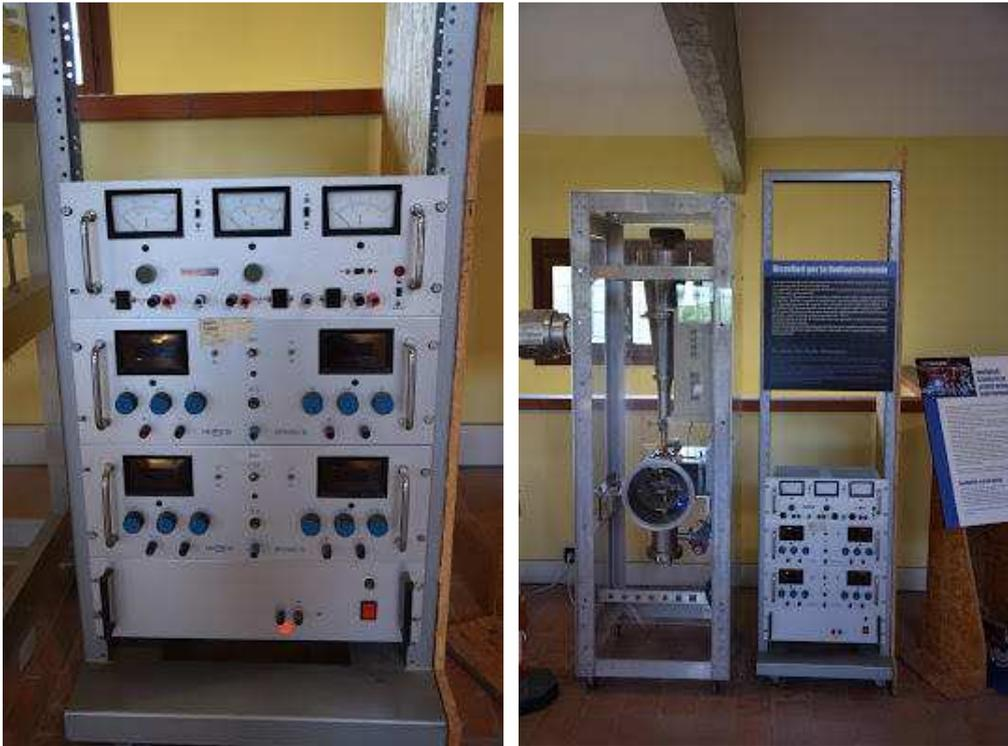
Nella foto che segue si vede un cilindro in alluminio dove all' interno è alloggiato il preamplificatore di segnale, per avere una riduzione del rumore di fondo ottimale l' interno è portato a bassissima temperatura.
