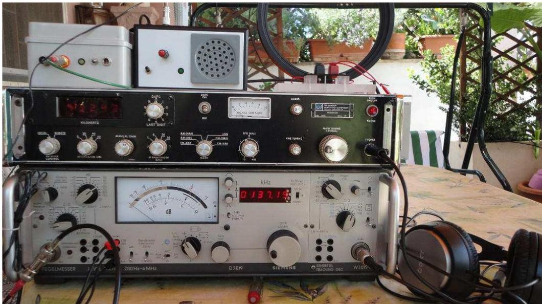
**Fig. 11 Voltmetro selettivo Siemens D2019—Ricevitore WJ 340a—Accessori**
