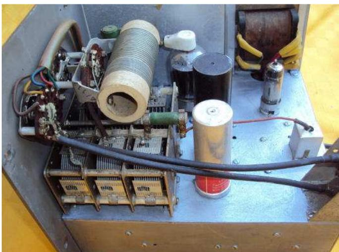
Sezione di alta frequenza e circuito di accordo
