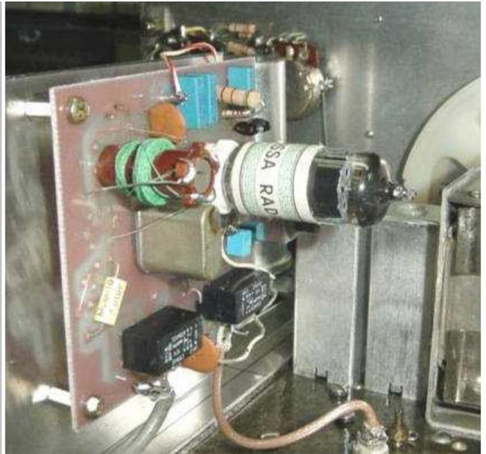
**Convertitore 160MT pronto per l'installazione    Installazione in verticale all'interno del ricevitore**
