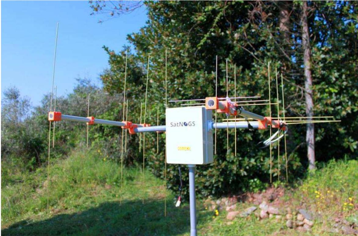
IZ5RZR - Un nuovi Kit per il Rotore SATNOGS V.2 è pronto per essere assemblato. Se qualcuno vuole fare il suo SATELLITE TRACKING SYSTEM , fatto con stampante 3D.
