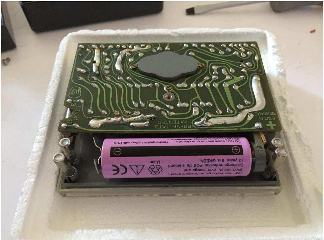
Figura 1: la nuova pila ha sostituito il vecchio elemento zinco-carbone; (foto De Vitis).
