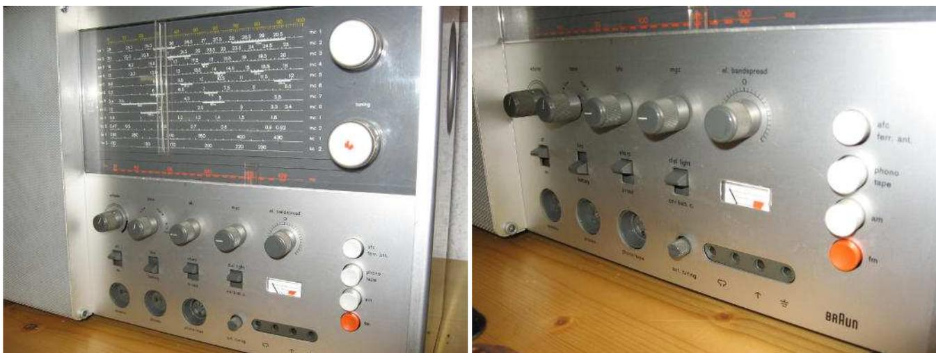
**Primo piano del comando Band Spread, dello strumentino S Meter / Batterie e delle prese per antenne esterne FM - OC e Terra.**
