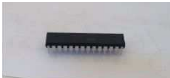
Figura 4: L'integrato 28 pin, dual-in-line, cuore del sistema.
