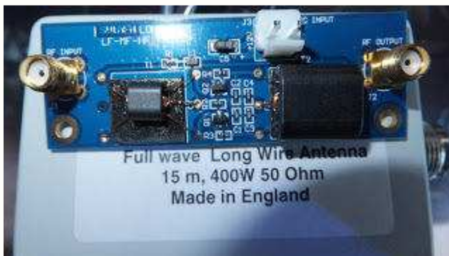
il Pre-Amp a Jfet due J310 in push pull
