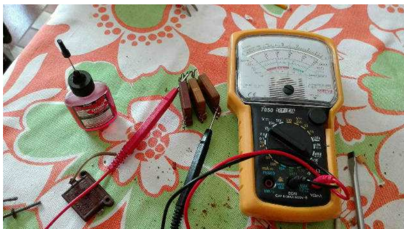
Condensatore da 220pF diventato una resistenza...
