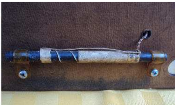
Bobina su ferrite fissata sul lato posteriore di cartone per le O.M
