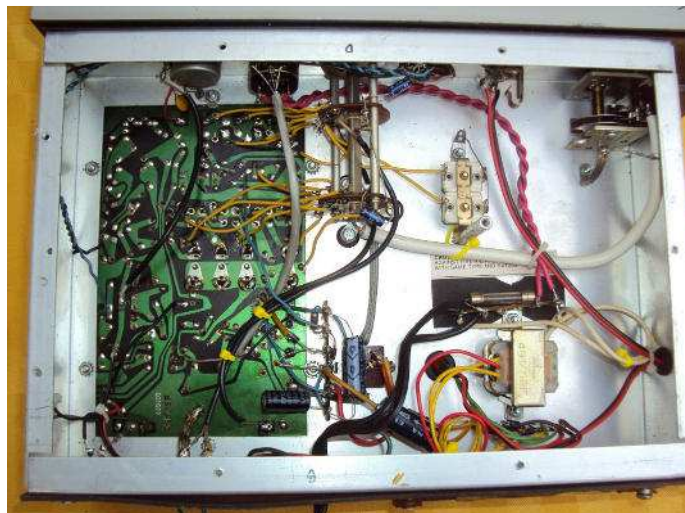
La sezione delle quattro bobine del circuito di A.F. e il variabile - Il circuito visto da sotto
