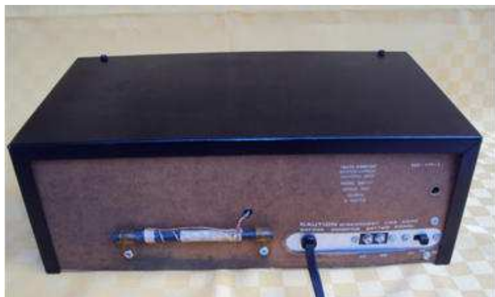
Bobina su ferrite fissata sul lato posteriore di cartone per le O.M
