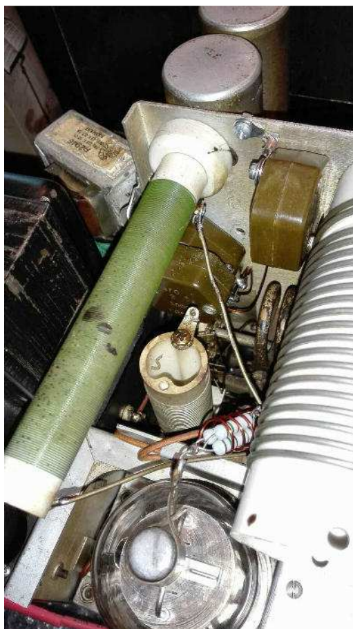
PA tuner con condensatori Sovietici e Parasitic suppressor nuovo
