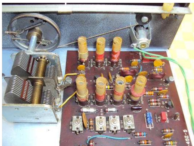
La sezione delle quattro bobine del circuito di A.F. e il variabile - Il circuito visto da sotto
