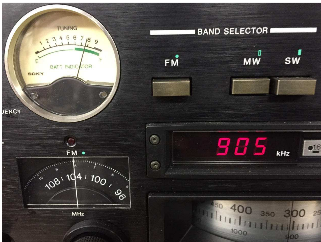
S meter , scala analogica dedicata all'FM, scala a tamburo tarata in KHz e il frequenzimetro dedicato
