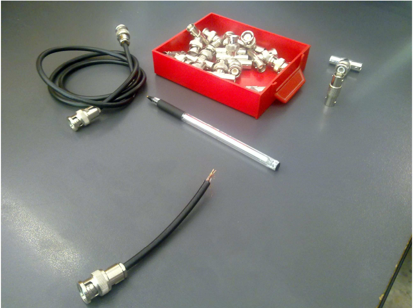
Figura 2: lo "stub" tagliato a misura, prima della saldatura finale.
