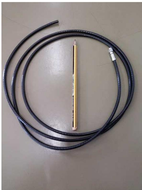
Figura 2: cavetto con connettore SMA;
