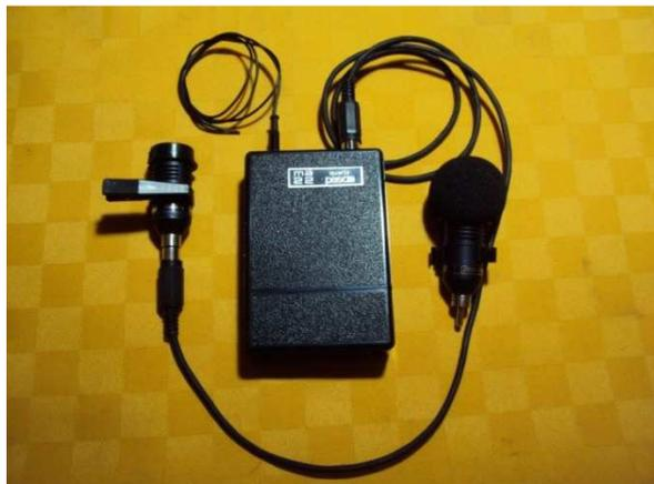
Radiomicrofono M 22 Paso con due microfoni uno da intervista e l'altro ad occhiello da fissare alla cravatta
