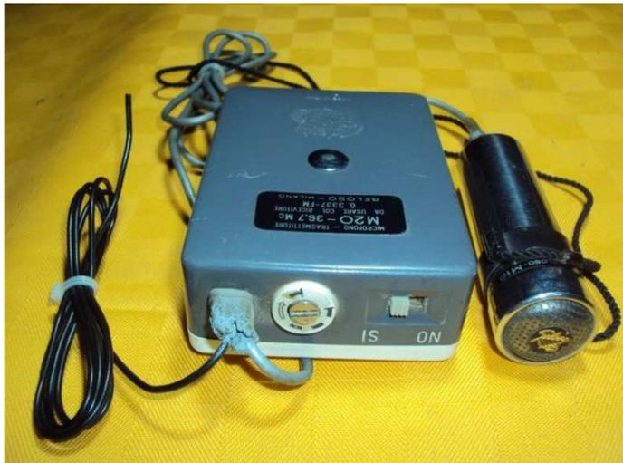
Radiomicrofono tascabile M 20 con microfono M 17
