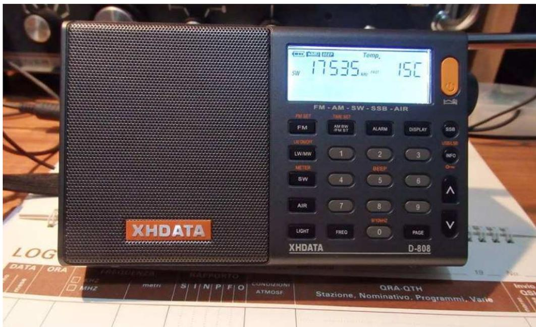
Ultimo arrivato, ottimo per il trasporto nello zaino per i miei ascolti in montagna, XHDATA D-808 Stereo FM / LW / MW / SW-SSB AIR RDS Ricevitore sintetizzato, <https://www.allmobileworld.it/.../manuali/XHDATA-D-808.it.pdf...>
