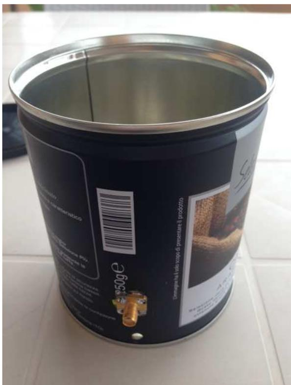
Figura 1: antenna completa, con connettore SMA;
