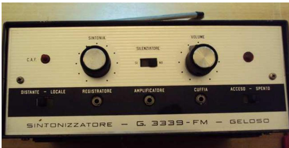
Sintonizzatore G 3339 seconda serie con circuito silenziatore ( squelch)
