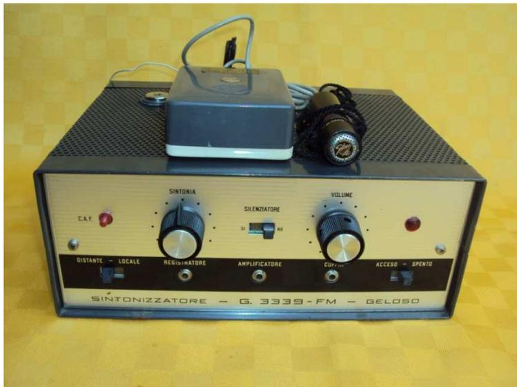
Radiomicrofono completo M 21 e sintonizzatore G. 3339 seconda serie
