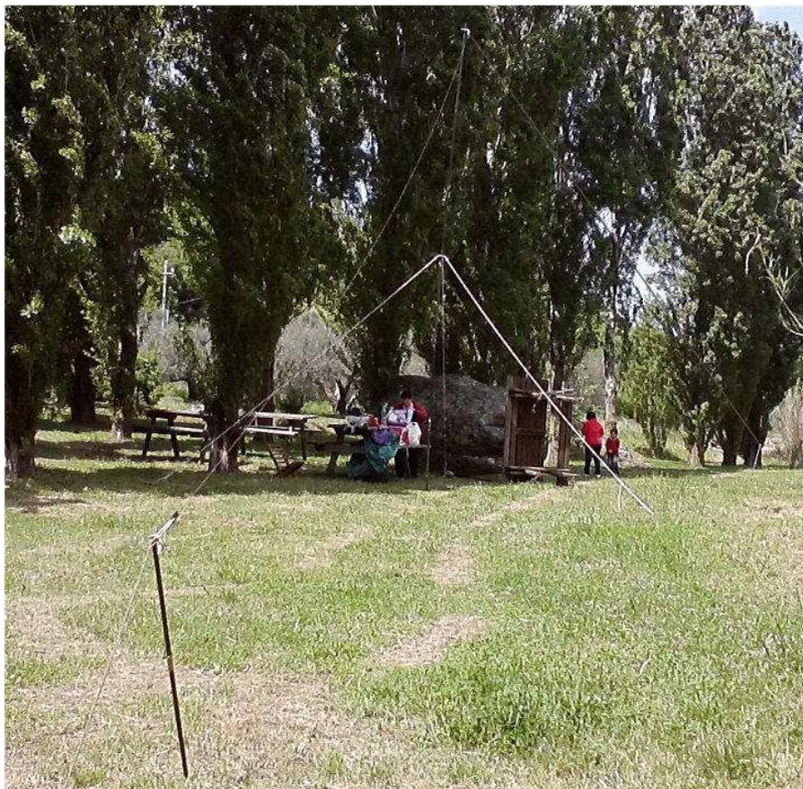
**Antenna NVIS filare (Doublet da 30 metri @ 7 metri di altezza) usata da IK0IXI/0 dal Lago di Bolsena in postazione "camping" (Aprile 2011)**
