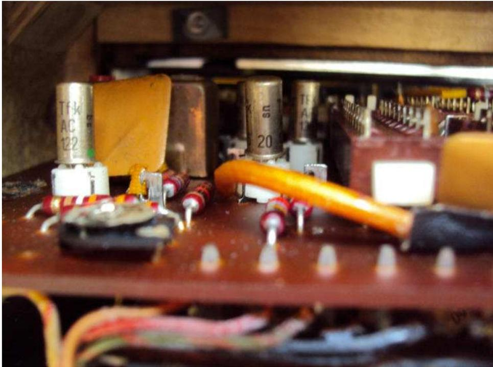
Ecco i famosi transistor Telefunken montati su zocolini fonte dei falsi contatti
