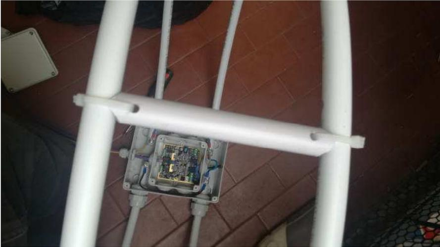
Infine ho montato il circuito di controllo remoto in una scatola di plastica per circuiti elettrici, montandoci 3 interruttori per commutare gli ingressi dell'amplificatore (se si ha più di una antenna):
