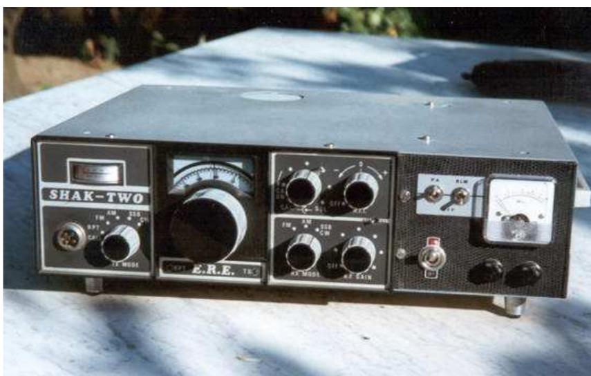
A completamento del ricetrasmittente vintage della E.R.E. **SHAK.TWO** modificato per operare in 50 Mc, (vedi Radiorama n° 69 e 70) ho ritenuto opportuno aggiungere un PA in Banda Laterale Unica, escludibile, includendo il tutto in un unico contenitore.
