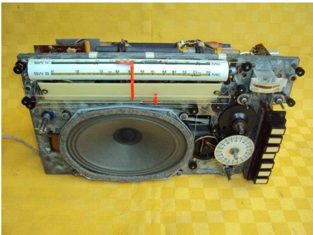
**Ricevitore nudo si nota la scala rotante per la sintonia delle OC**
