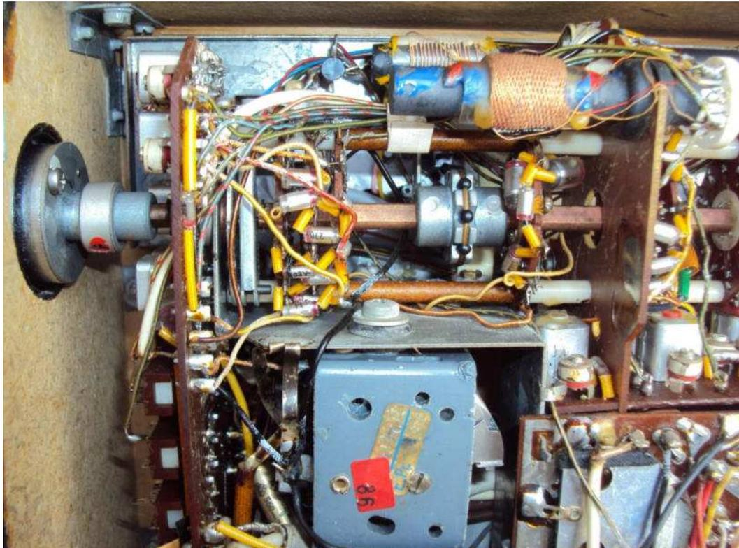
**selettore rotante per OC e la ferrite con la bobina per OL**
